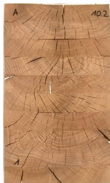
nach Prüfung Verfahren C; Delaminierung gesamt= 10.1%
