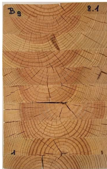
nach Prüfung Verfahren B; Delaminierung gesamt = 1.5%
