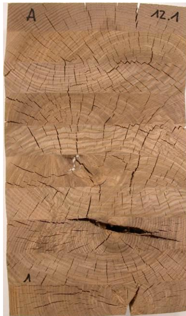
nach Prüfung Verfahren B; Delaminierung gesamt = 0.2%
