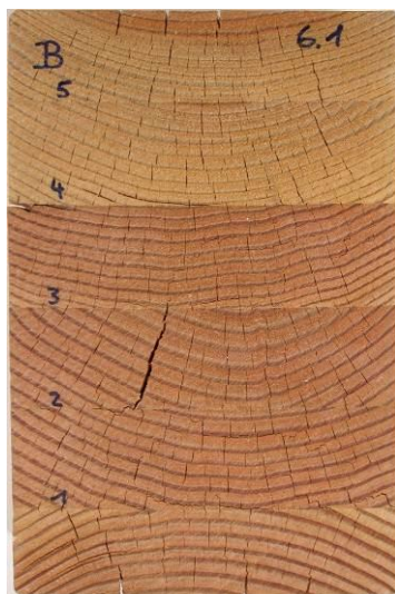
nach Prüfung Verfahren B; Delaminierung gesamt = 0.8%
