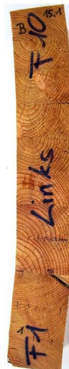
nach Prüfung Verfahren B; Delaminierung gesamt = 12.2%
