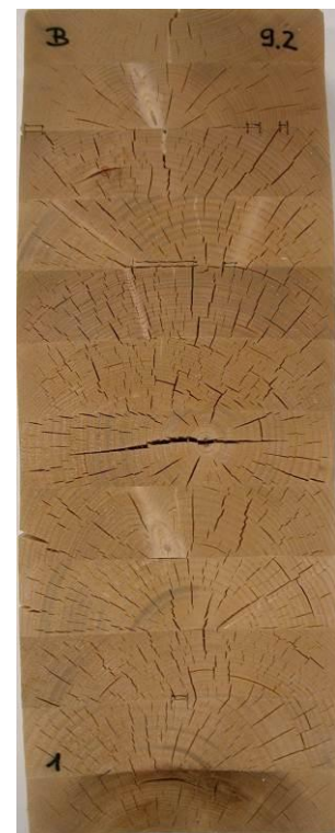
nach Prüfung Verfahren A; Delaminierung gesamt= 1.3%
