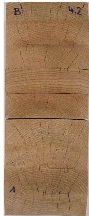
nach Prüfung Verfahren C; Delaminierung gesamt= 40.1%
