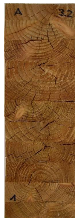
nach Prüfung Verfahren A; Delaminierung gesamt = 3.1%
