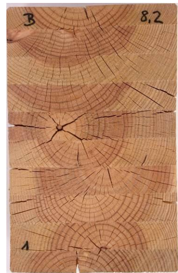
nach Prüfung Verfahren A; Delaminierung gesamt= 0.1%
