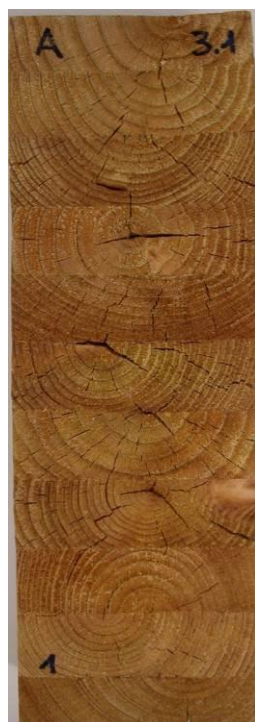
nach Prüfung Verfahren B; Delaminierung gesamt = 0.9%
