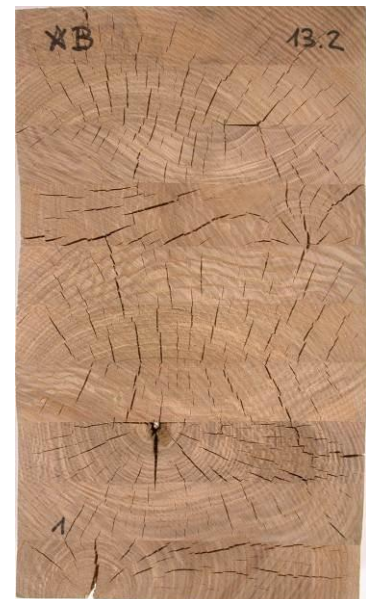
nach Prüfung Verfahren C; Delaminierung gesamt= 2.0%
