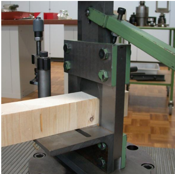
Abbildung 5.4: Empa-Blockscher-Prüfvorrichtung mit geriffelter Auflage, Prüfung ohne Klemmung des Prüfkörpers (Abheben möglich)
