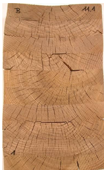
nach Prüfung Verfahren B; Delaminierung gesamt = 10.9%
