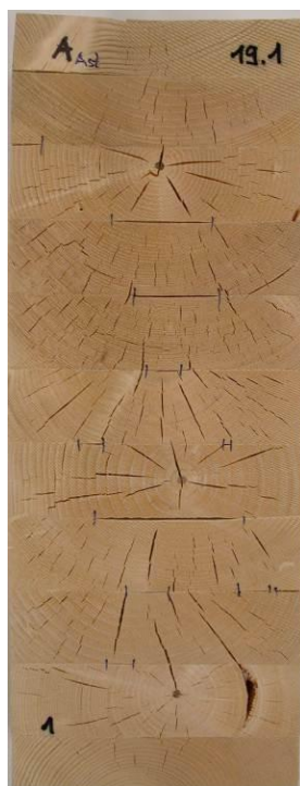
nach Prüfung Verfahren B; Delaminierung gesamt = 14.7%
