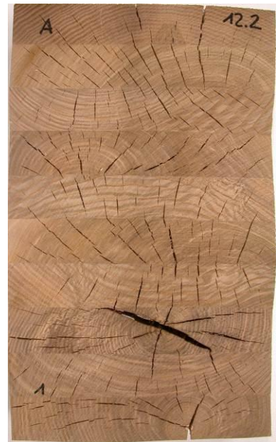
nach Prüfung Verfahren C; Delaminierung gesamt= 0.0%
