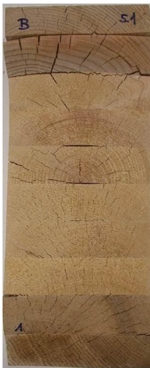
nach Prüfung Verfahren B; Delaminierung gesamt = 23.9%
