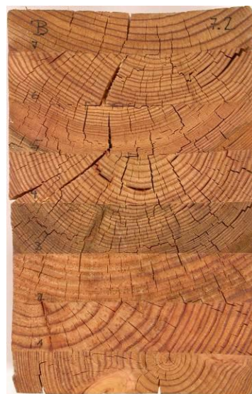
nach Prüfung Verfahren A; Delaminierung gesamt= 1.1%
