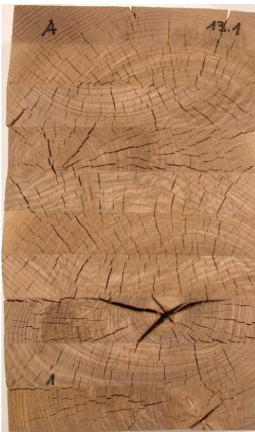
nach Prüfung Verfahren B; Delaminierung gesamt = 0.7%
