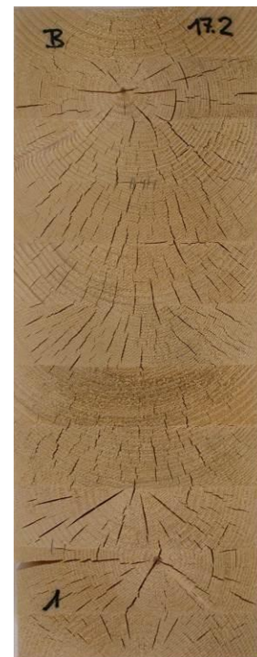
nach Prüfung Verfahren A; Delaminierung gesamt=2.0%
