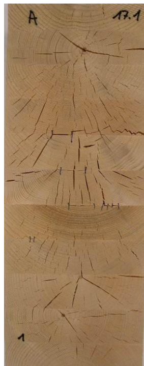
nach Prüfung Verfahren B; Delaminierung gesamt = 4.0%
