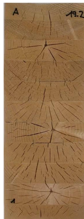
nach Prüfung Verfahren A; Delaminierung gesamt= 14.2%
