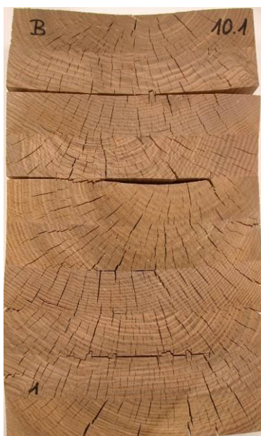
nach Prüfung Verfahren B; Delaminierung gesamt = 19.3%
