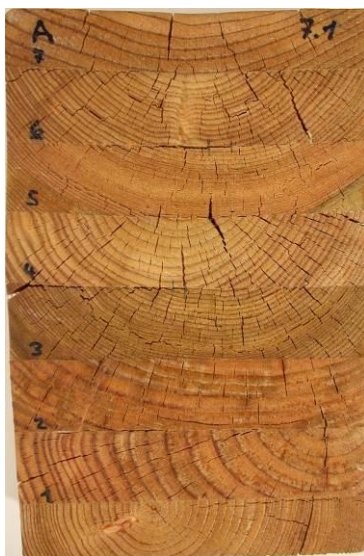
nach Prüfung Verfahren B; Delaminierung gesamt = 1.8%
