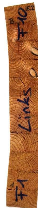
nach Prüfung Verfahren A; Delaminierung gesamt= 10.1%
