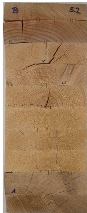
nach Prüfung Verfahren C; Delaminierung gesamt= 18.9%
