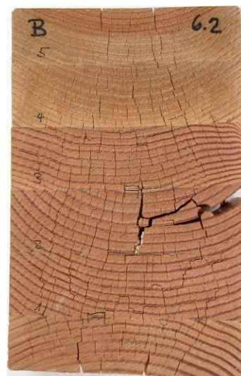
nach Prüfung Verfahren A; Delaminierung gesamt= 3.4%
