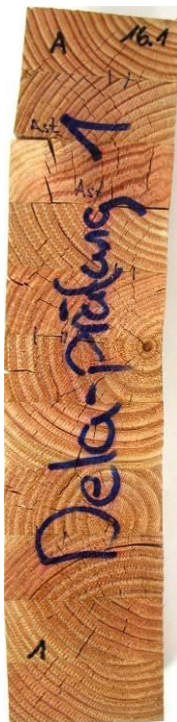
nach Prüfung Verfahren B; Delaminierung gesamt = 5.0%
