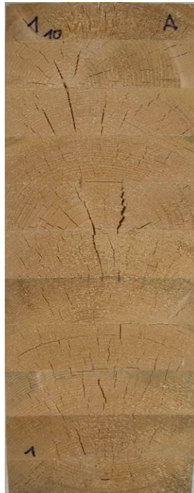
nach Prüfung Verfahren B; Delaminierung gesamt = 3.5%
