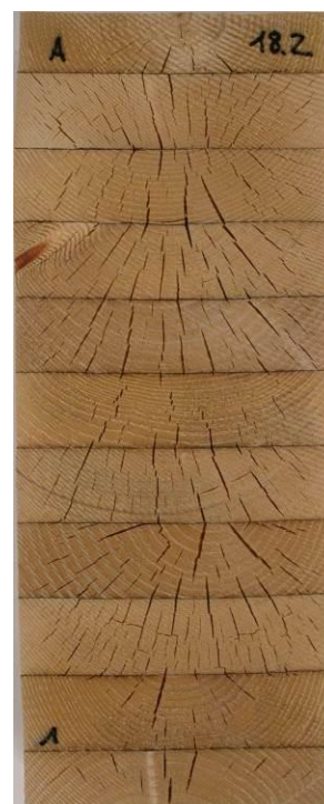
nach Prüfung Verfahren A; Delaminierung gesamt= 0.2%
