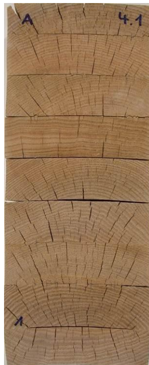
nach Prüfung Verfahren B; Delaminierung gesamt = 85.2%
