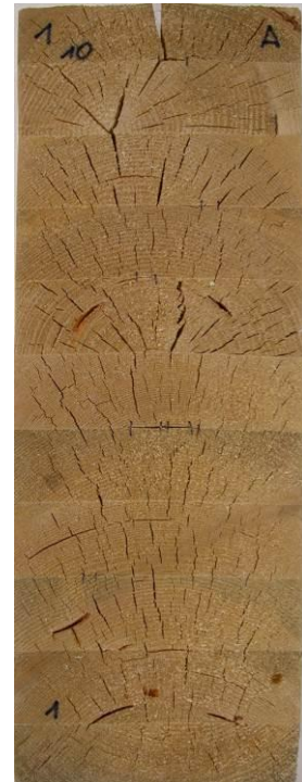
nach Prüfung Verfahren A; Delaminierung gesamt= 6.0%
