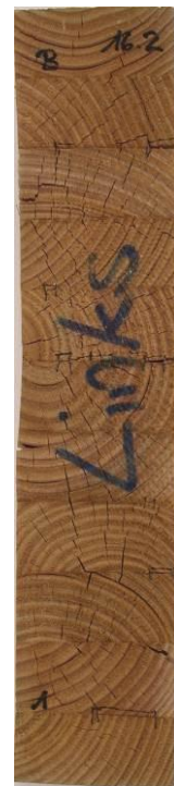
nach Prüfung Verfahren A; Delaminierung gesamt= 10.1%
