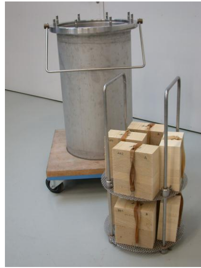
Abbildung 5.3: Probenkorb und Vakuum-Druckkessel für die Wässerung der Delaminierungs-Proben
