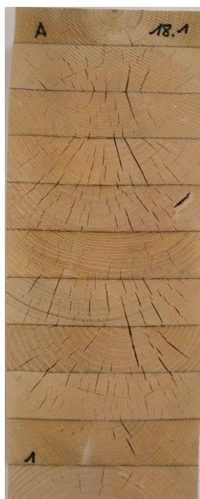
nach Prüfung Verfahren B; Delaminierung gesamt = 0.0%
