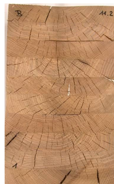
nach Prüfung Verfahren C; Delaminierung gesamt= 22.4%
