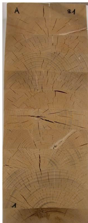
nach Prüfung Verfahren B; Delaminierung gesamt = 1.0%
