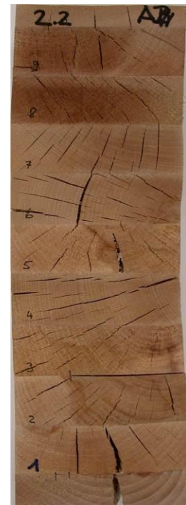
nach Prüfung Verfahren A; Delaminierung gesamt= 9.9%
