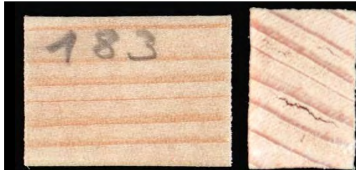
Abbildung 27: ausgewaschene Probe von Variante 1 mit Poria placenta inkubiert (6Wo)
