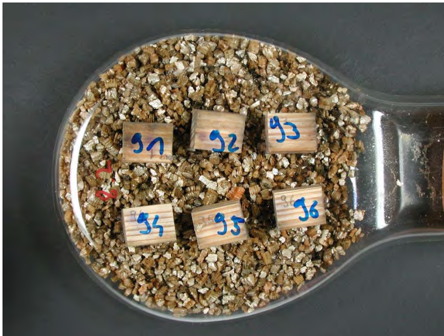
Abbildung 19: Kolleflasche mit eingebauten Holzproben.
