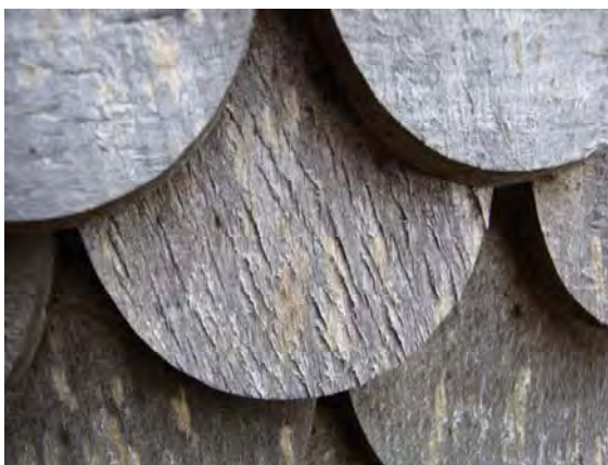
Abb. 25 Bucheschindeln mit aufgerissener Oberfläche im Bereich der Holzstrahlen, Buche Süd-exponiert nach 26 Monaten Bewitterung
