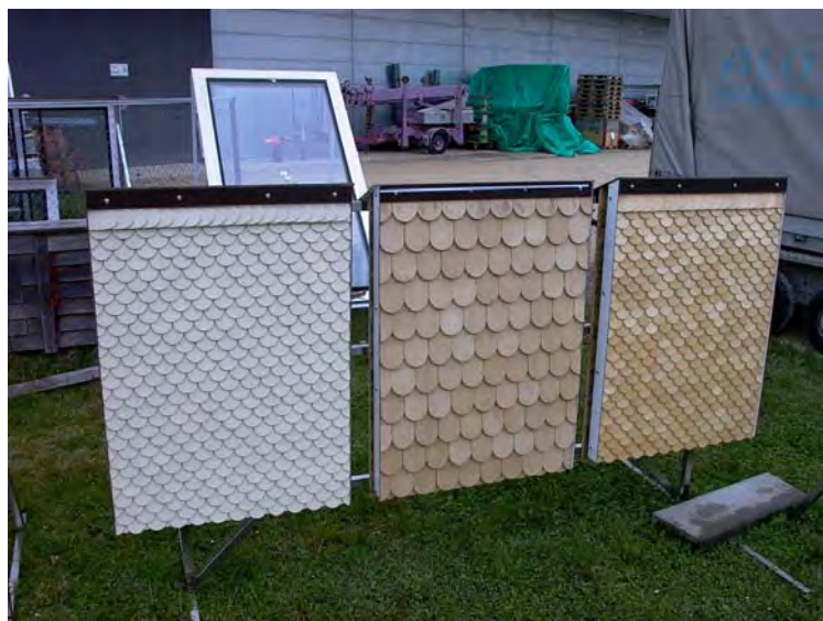
Abb. 8 Musterflächen am Bewitterungsstand an der BFH-AHB (links Bucheschindeln maschinengeschnitten und deckend beschichtet, Mitte Bucheschindeln gesägt, rechts Fichteschindeln maschinengeschnitten unbehandelt)
