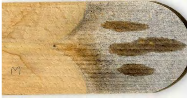
Abb. 21 Aufgesaugte Wassertropfen auf einer gesägten Bucheschindel kurz nach der Aufbringung zeigen den ausgeprägten hydrophilen Charakter dieser Oberfläche
