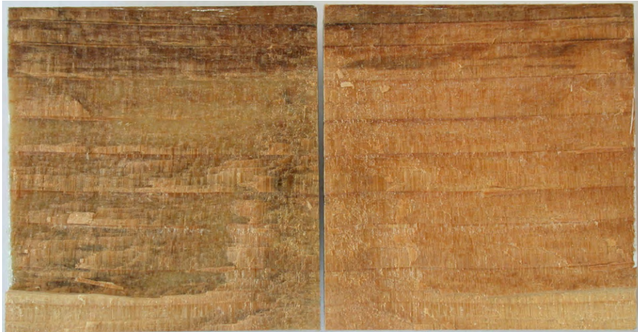
Bild 22: Scherfläche des Prüfkörpers QSS 8 / R / Fuge 7 mit einer Scherfestigkeit von 4.7 \text{ N/mm}^2 . Der Prüfkörper wurde aus einem sanierten Trägerbereich geschnitten. Auf dem linken Teil ist der vollständig mit Holzfasern behaftete PUR-Klebstofffilm erkennbar (Kohäsionsbruch). Der relativ tiefe Festigkeitswert dürfte auf das in den Grenzzonen geschwächte Holz und auf die Verschmutzung zurückzuführen sein.
