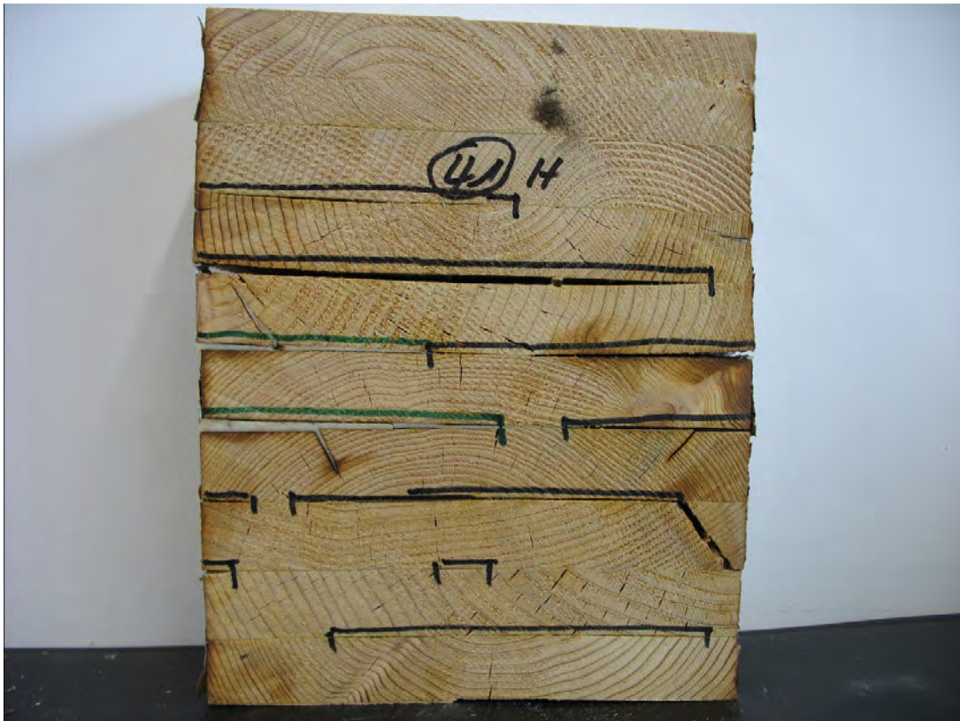
Bild 24: Fugenöffnungen an alten (schwarz) und ausgefüllten Klebfugen (grün) nach der Delaminationsprüfung
