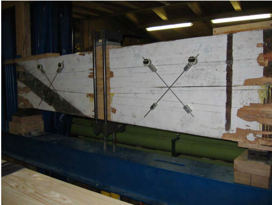
Bild 26: Ansicht der Trägers mit den Messvorrichtungen vor der Belastung
