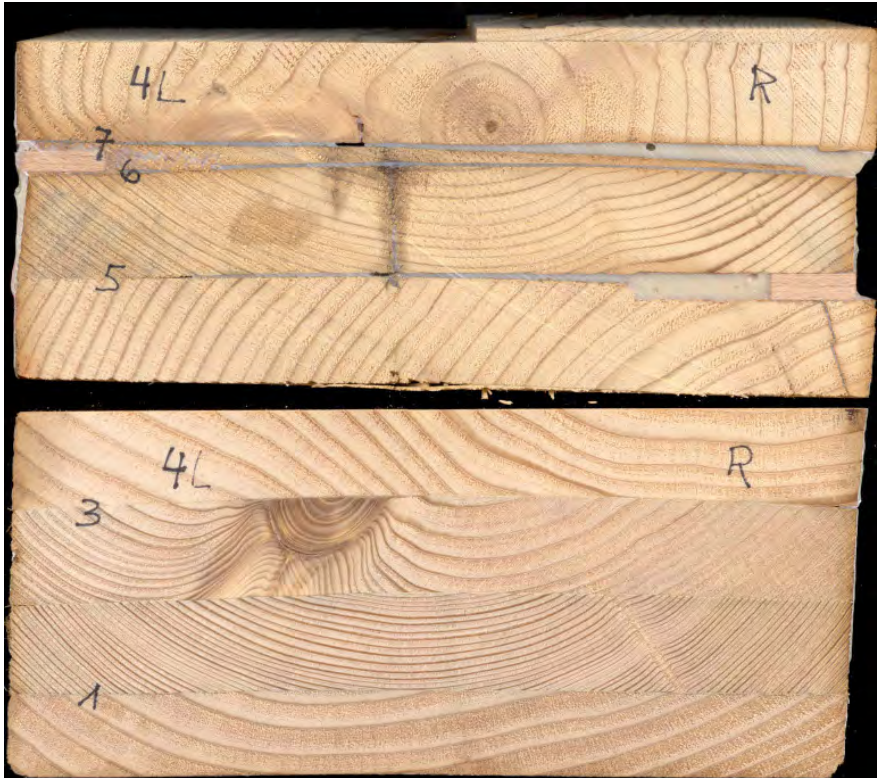
Bild 16: Querschnittsprobe 4 aus dem unteren (Fuge 1 bis 3) und mittleren Bereich (Fuge 5 bis 7) des Trägers (Fuge 4 = Schnitt). Die vor der Sanierung offenen Fugen 5, 6 und 7 sind mit PUR-Klebstoff gefüllt. In den Fugen 5 (rechts) und 6 (links) sind die bei der Sanierung eingesetzten Dübel sichtbar.
