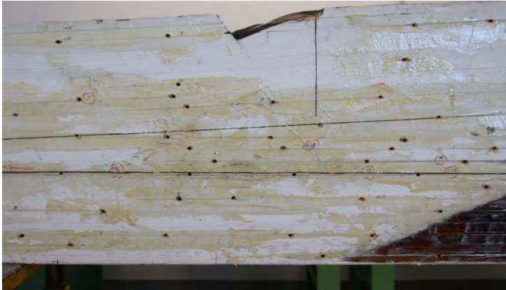
Bild 9: Trägeroberfläche mit Bohrlöchern
