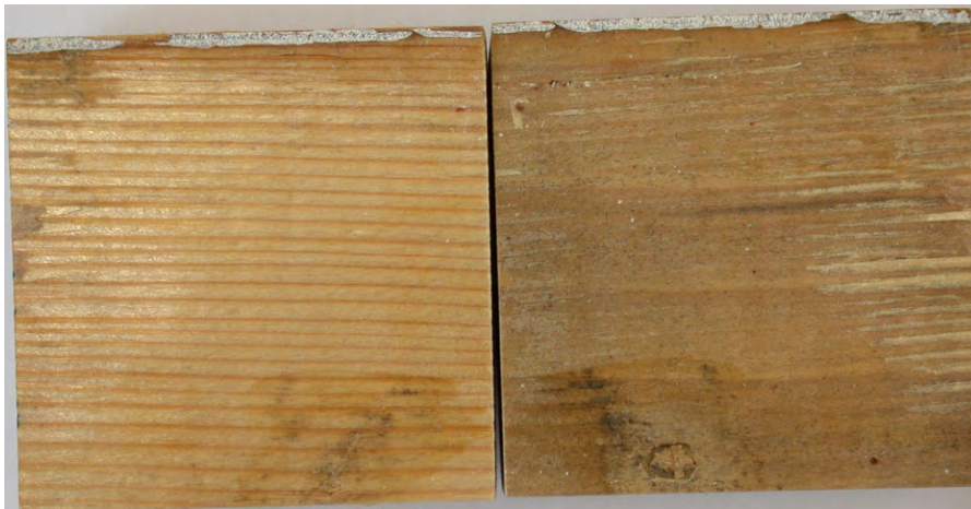
Bild 20: Scherfläche des Prüfkörpers QSS 1/ R / Fuge 1 mit einer Scherfestigkeit von 1.9 N/mm 2 und sehr geringem Faserausriss. Die Klebfläche rechts ist verfärbt/verschmutzt.
