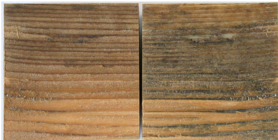
Bild 21: Scherfläche des Prüfkörpers QSS 39/ R / Fuge 8 mit einer Scherfestigkeit von 5.6 N/mm 2 . Der Prüfkörper wurde aus einem sanierten Trägerbereich geschnitten. Auf dem rechten Teil ist der teilweise mit Holzfasern behaftete PUR-Klebstofffilm sichtbar. Der Bruch der Klebfuge erfolgte grösstenteils im Grenzbereich zwischen Holz und PUR-Klebstoff (Adhäsionsbruch). Es ist anzunehmen, dass eine bessere Adhäsion zwischen Holz und Klebstoff durch die Verschmutzung verhindert wurde.
