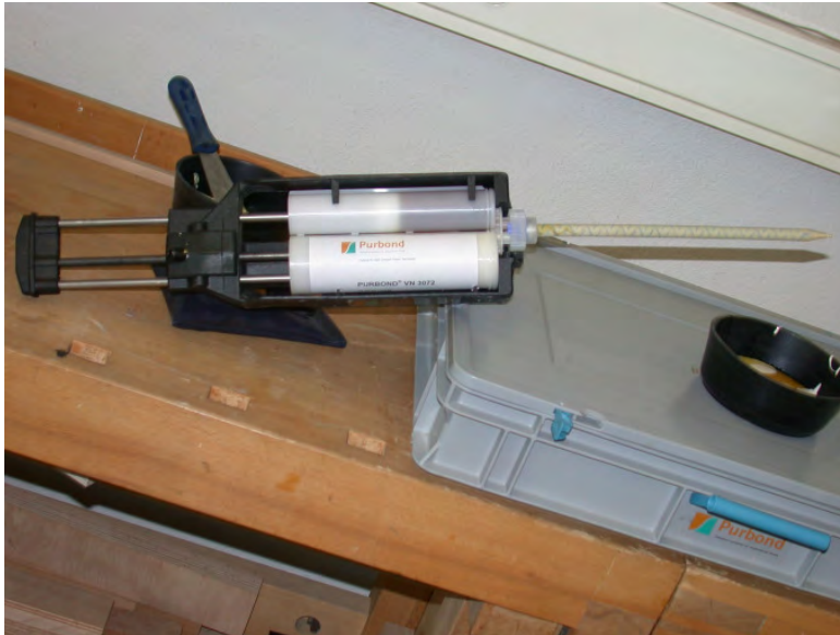
Bild 5: Injektionswerkzeug mit eingesetzten Kartuschen zum Verschliessen der Oberflächen
