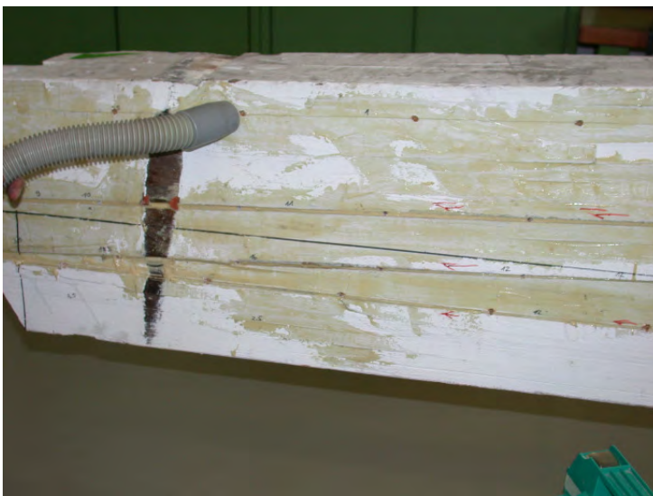
Bild 8: Absaugen der Bohrlöcher mit Industriestaubsauger
