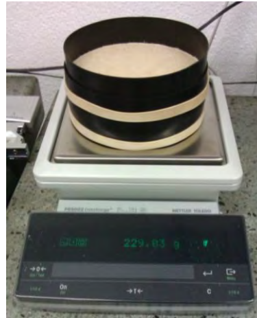
Abbildung 5.8: Massenbestimmung der Prüfscheibe
