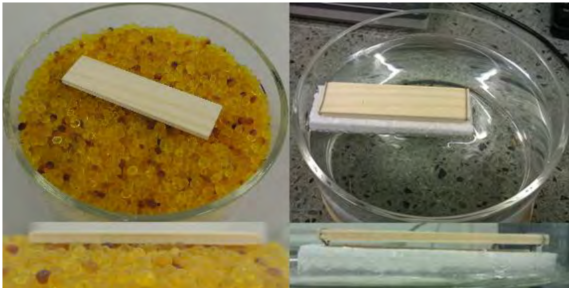
Abbildung 6.13: Fichtenholzplättchen beim Dry- und Wet-Cup-Versuch
