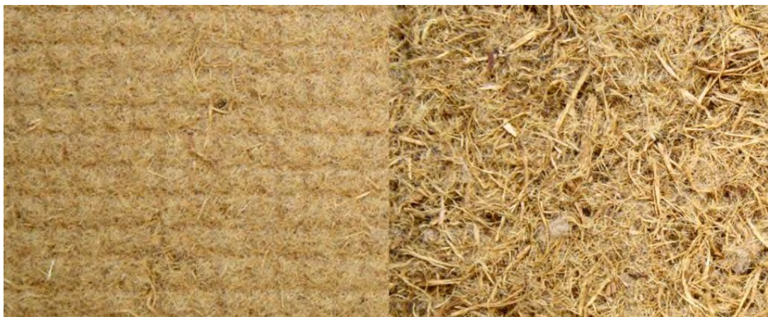
Abbildung 6.8: Plattenoberflächen bei Pavaflex (links Oberseite, rechts Unterseite)
