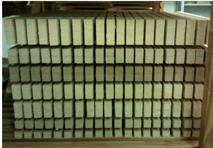
Abbildung 5.10: Quellen und Schwinden Lagerung im Klimaraum
