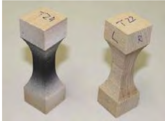
Abbildung 3 Prüfkörper für Zugversuche mit Belastung in radialer und tangentialer Richtung (linker Prüfkörper mit Speckle-Muster für die Anwendung der DIC-Methode)
