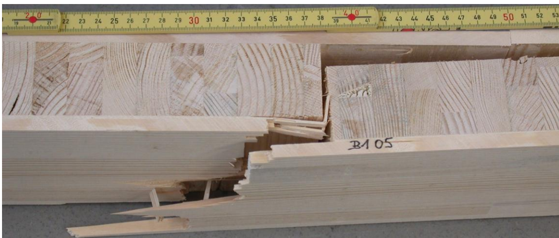
Abbildung 3.15: Prüfkörper mit kombiniertem Biege-Schubbruch Typ 2. Die Decklage in der Zugzone ist gebrochen und der in einer vertikalen Fuge in der Mittellage hat sich ein Schubbruch ergeben.
