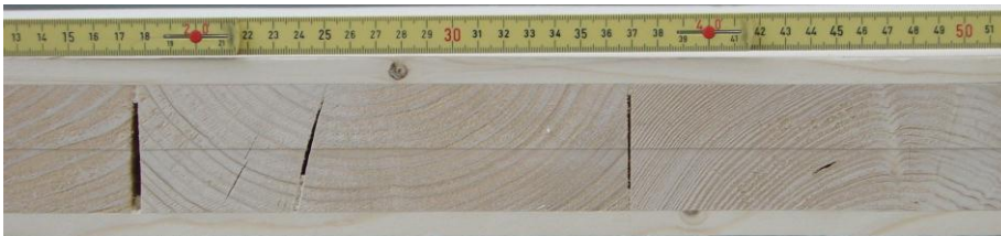
Abbildung 3.2: Querschnitt eines Prüfkörpers der Serie A mit in Längsrichtung verlaufenden Decklagen und rechtwinklig dazu angeordneter Mittellage, Aufbau 10-50-10 mm. Die Mittellage besteht aus Brettern mit einer Breite von i.d.R. 190 mm bis 230 mm. Die Bretter sind auf der Breitseite mit den Decklagen verklebt. Auf der Schmalseite sind die Bretter der Mittellage nicht verklebt und weisen mehrheitlich einen Zwischenraum auf.
