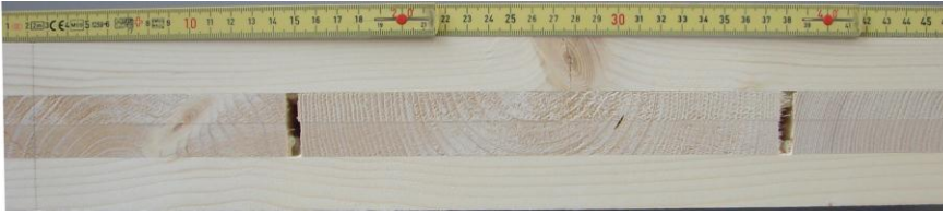
Abbildung 3.4: Querschnitt eines Prüfkörpers der Serie A mit in Längsrichtung verlaufenden Decklagen und rechtwinklig dazu angeordneter Mittellage, Aufbau 25-30-25 mm. Die Mittellage besteht aus Brettern mit einer Breite von i.d.R. 190 mm bis 230 mm. Die Bretter sind auf der Breitseite mit den Decklagen verklebt. Auf der Schmalseite sind die Bretter der Mittellage nicht verklebt und weisen mehrheitlich einen Zwischenraum auf.
