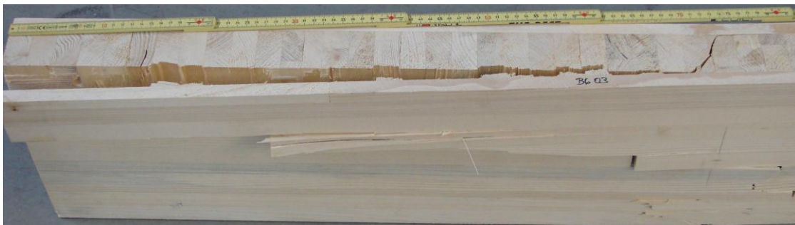
Abbildung 3.14: Prüfkörper mit kombiniertem Biege-Schubbruch Typ 1. Die Decklage in der Zugzone ist teilweise gebrochen und die Decklage(n) sind teilweise abgelöst.
