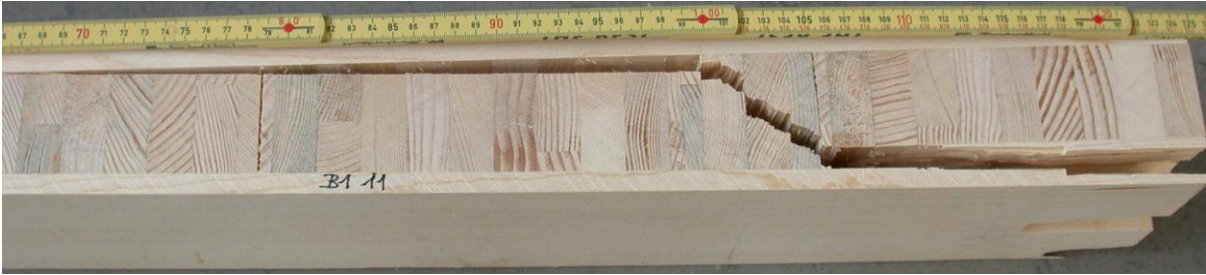
Abbildung 3.16: Prüfkörper mit Schubbruch Typ 1. Die Decklage in der Zugzone ist nicht gebrochen.
