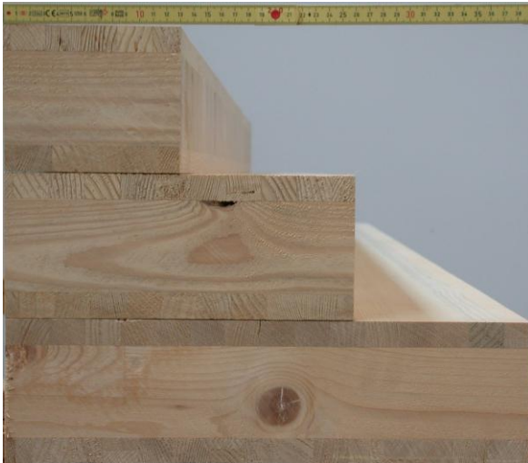
Abbildung 3.9: Querschnitt der Prüfkörper der Serie B mit dem Aufbau 20-70-20 mm, in den Breiten (von unten nach oben) 390 mm, 260 mm und 130 mm. Die Lamellenbreite der Decklagen beträgt 26 mm.
