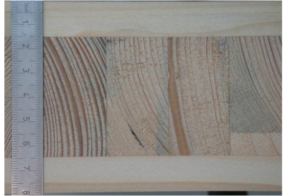
Abbildung 3.8: Querschnitt mit in Längsrichtung verlaufenden Decklagen und rechtwinklig dazu angeordneter Mittellage eines Prüfkörpers der Serie B, Aufbau 15-50-15 mm. Die Mittellage besteht aus 26 mm breiten, untereinander und mit den Decklagen verklebte Lamellen.
