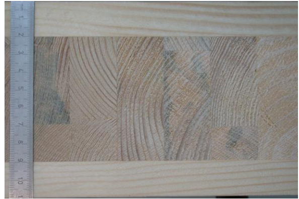
Abbildung 3.10: Querschnitt mit in Längsrichtung verlaufenden Decklagen und rechtwinklig dazu angeordneter Mittellage eines Prüfkörpers der Serie B, Aufbau 20-70-20 mm. Die Mittellage besteht aus 26 mm breiten, untereinander und mit den Decklagen verklebte Lamellen.
