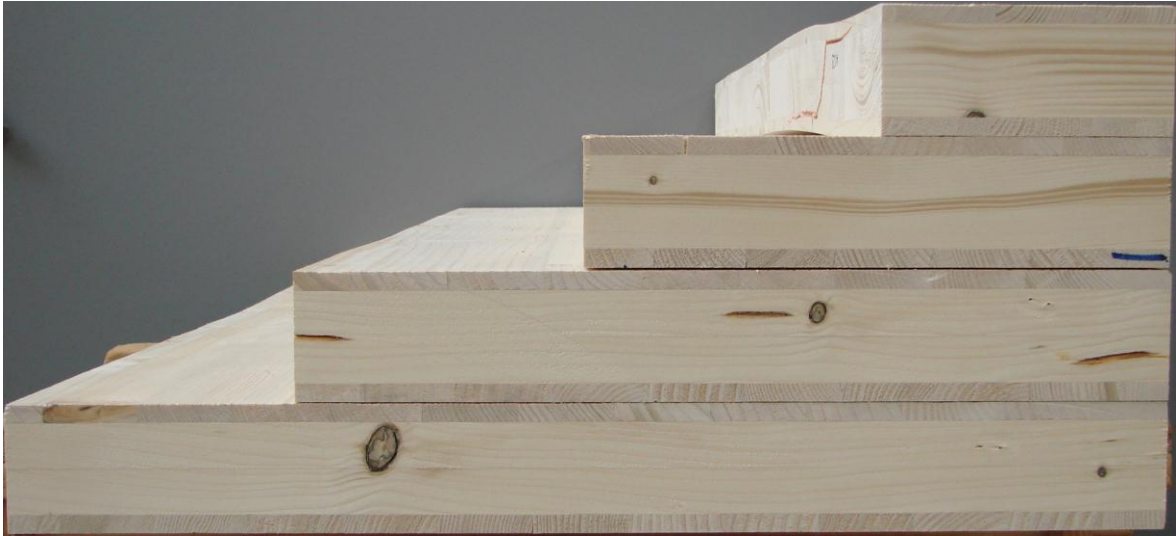
Abbildung 3.1: Querschnitt der Serie A-Prüfkörper mit dem Aufbau 10-50-10 mm, in den Breiten (von unten nach oben) 624 mm, 468 mm, 312 mm und 156 mm. Lamellenbreite der Decklagen = 52 mm.
