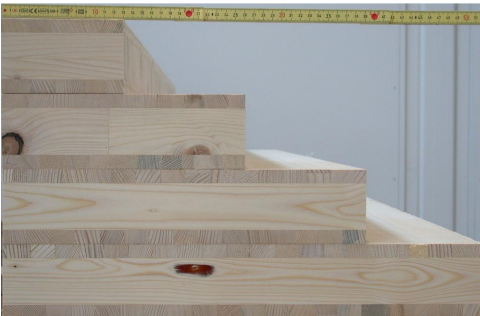
Abbildung 3.6: Querschnitt der Serie B-Prüfkörper mit dem Aufbau 15-50-15 mm, in den Breiten (von unten nach oben) 520 mm, 390 mm, 260 mm und 130 mm. Lamellenbreite der Decklagen = 26 mm.
