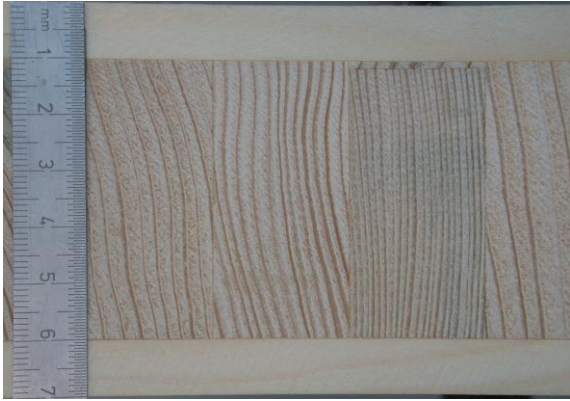
Abbildung 3.7: Querschnitt mit in Längsrichtung verlaufenden Decklagen und rechtwinklig dazu angeordneter Mittellage eines Prüfkörpers der Serie B, Aufbau 10-50-10 mm. Die Mittellage besteht aus 26 mm breiten, untereinander und mit den Decklagen verklebte Lamellen.
