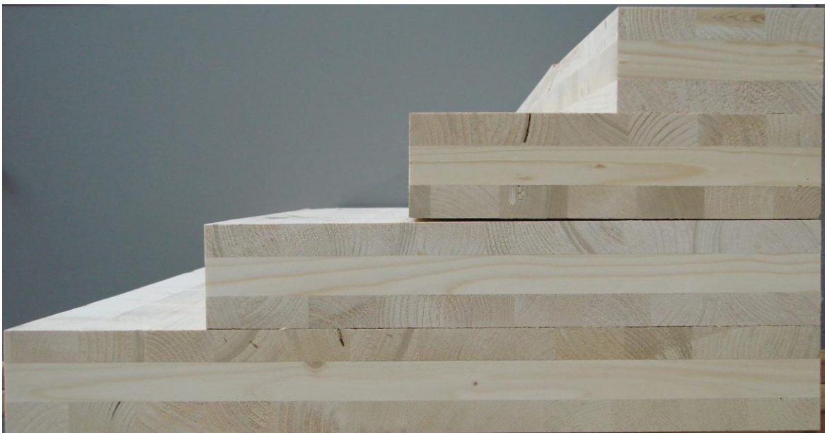
Abbildung 3.3: Querschnitt der Serie A-Prüfkörper mit dem Aufbau 25-30-25 mm, in den Breiten (von unten nach oben) 624 mm, 468 mm, 312 mm und 156 mm. Lamellenbreite der Decklagen = 52 mm.
