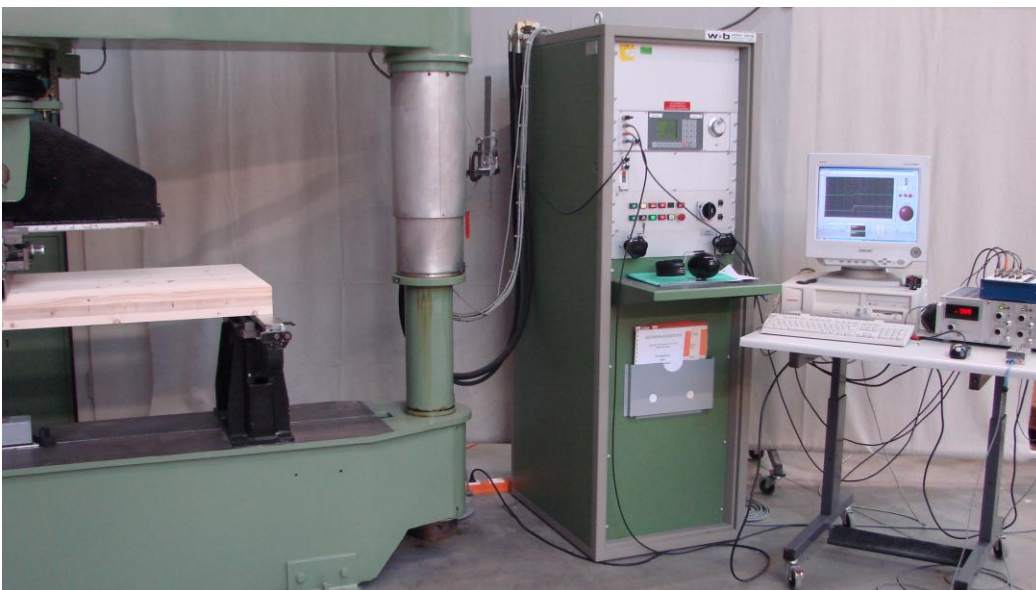
Abbildung 3.12: Hydraulische Steuerungseinheit des Typs Walter & Bai und Datenerfassungseinheit mit Messverstärker, Labview-Datenerfassungseinheit und PC.
