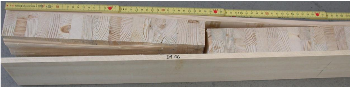
Abbildung 3.17: Prüfkörper mit Schubbruch Typ 2: Der Scherfestigkeit einer Klebstofffuge in der Mittellage wurde überschritten, worauf die Verklebung der Mittellage mit den Decklagen auf Querkzug versagte.
