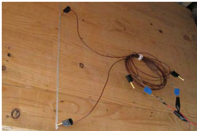
Abbildung 4-2: Applizierte Riss-Sensoren bei einem Vorversuch an einer Brücke
