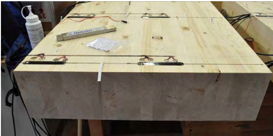
Abbildung 4-10: Dehnungsmesssensoren im blockverleimtem Prüfkörper
