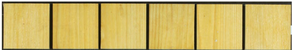
Abbildung 69 Schimmelpilzbewuchs nach 6 Wochen auf der Alkyd/Acrylharzbeschichtung mit Biozid (4); Proben oberflächlich gereinigt
