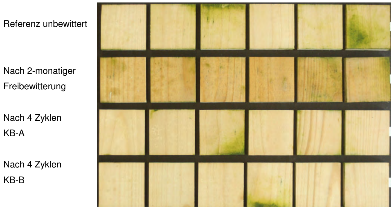
Abbildung 74 Algenbewuchs nach 12 Wochen auf der öligen Alkydharzbeschichtung mit Silber (3)
