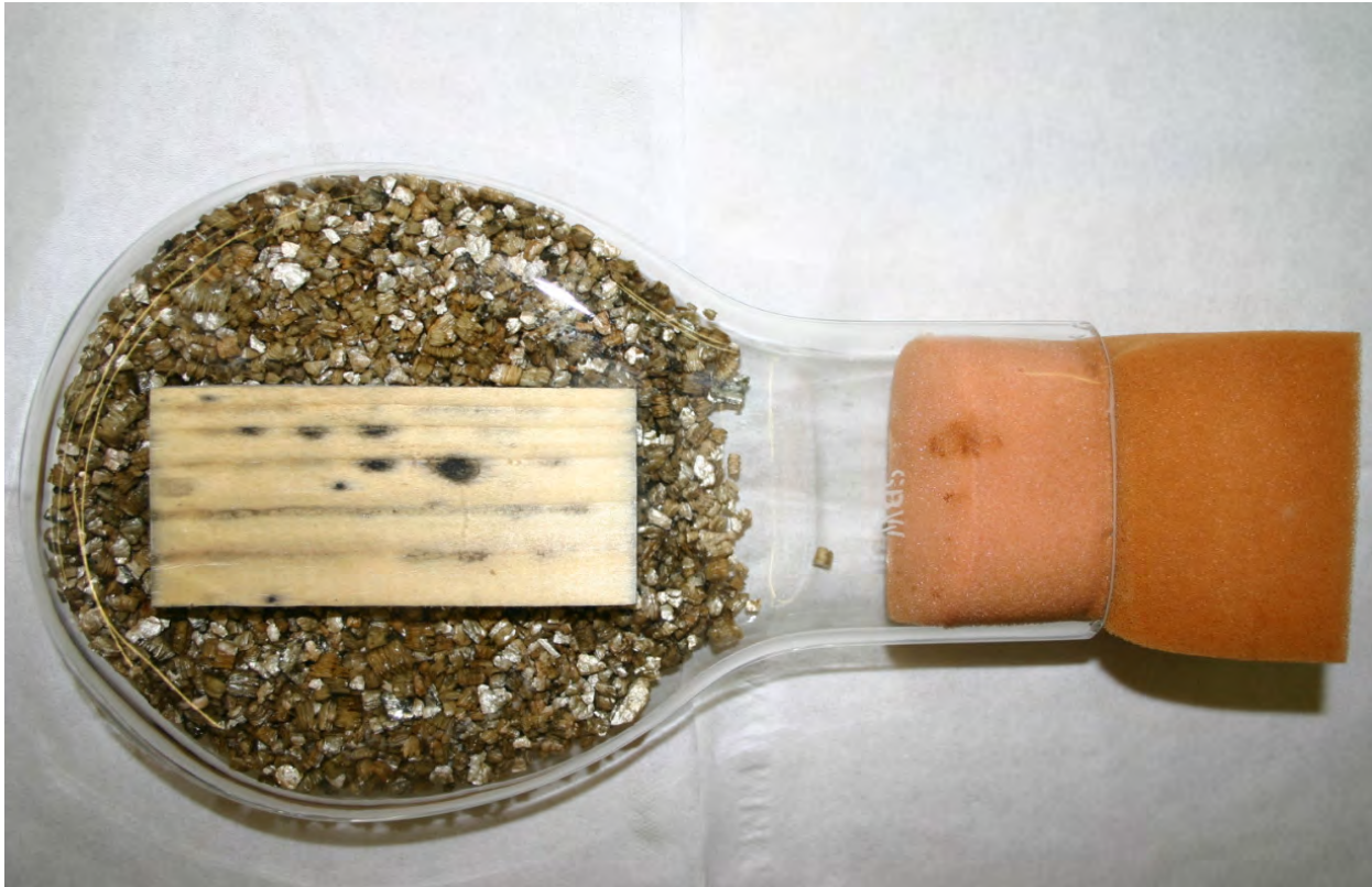
Abbildung 17 Versuchsgefäss mit Probe; Test mit Bläuepilzen
