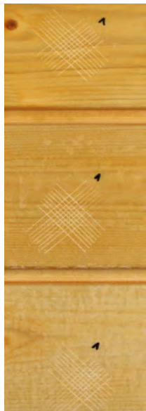
Abbildung 61 Gitterschnittprüfung; Alkydharz mit Biozid (5)
