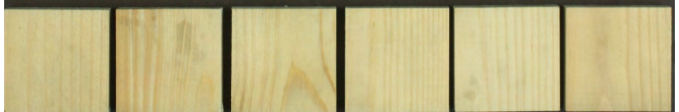
Abbildung 67 Schimmelpilzbewuchs nach 6 Wochen auf der Hydrophobierung ohne Silber (2); Proben oberflächlich gereinigt
