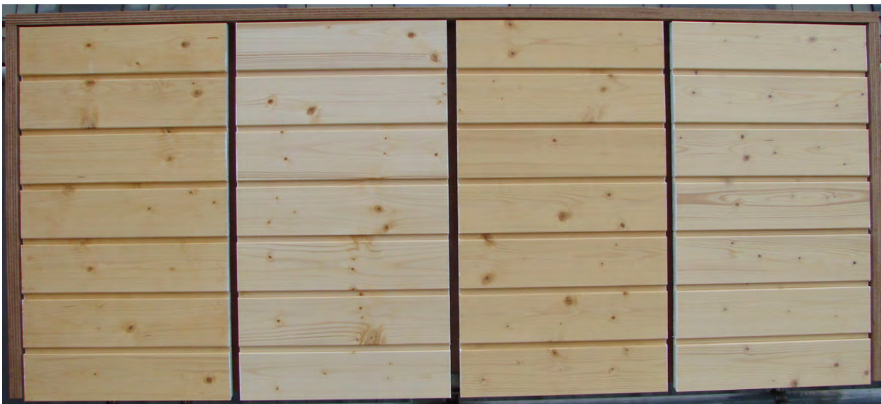
Abbildung 46 Proben vor dem Start der Freibewitterung (von links: Hydrophobierung mit Silber, Ölige Alkydharz mit Silber, Hydrophobierung ohne Silber, Alkyd/Acrylharz mit Biozid)
