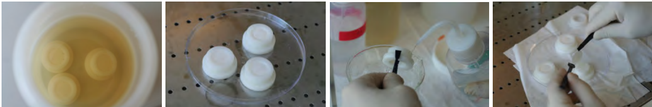
Abbildung 20 DGT Methode (DGT-Einheiten im Ablaufwasser; Entnahme des Ionenaustauscherharzes)
