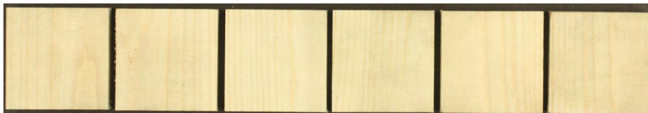
Abbildung 71 Schimmelpilzbewuchs nach 6 Wochen auf Fichte; Proben oberflächlich gereinigt
