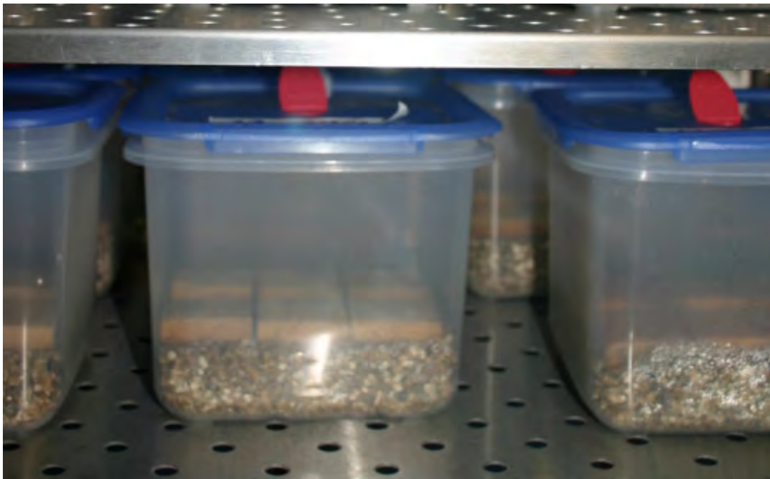
Abbildung 18 Versuchsgefäss mit Proben; Test mit Schimmelpilzen
