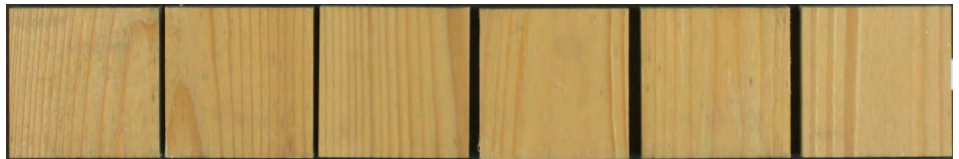
Abbildung 69 Schimmelpilzbewuchs nach 6 Wochen auf der Alkyd/Acrylharzbeschichtung mit Biozid (4); Proben oberflächlich gereinigt
