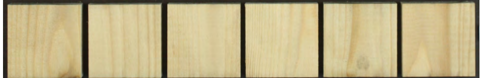
Abbildung 66 Schimmelpilzbewuchs nach 6 Wochen auf der Hydrophobierung mit Silber (1); Proben oberflächlich gereinigt
