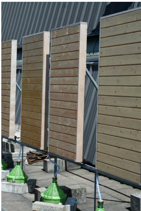
Abbildung 12 Freibewitterungsstand; Elemente mit Auffangeinrichtung für Ablaufwasser
