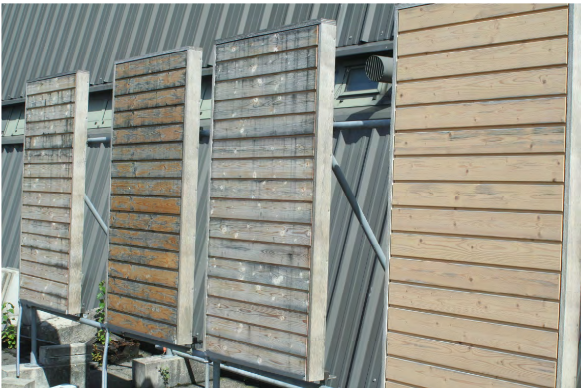
Abbildung 85 Fassadenelemente nach 27 Monaten Freibewitterung (von links: Beschichtung (1), (3), (2) und (4))
