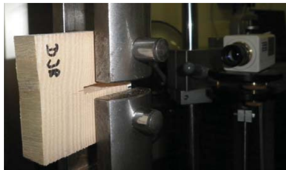
Abb. 2.4 Eingespannte CT-Probe (links), Videoextensometer (rechts)
