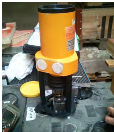
Abbildung 45: Mobiles Haftzugprüfgerät der Fa. BTS Baucontrol
