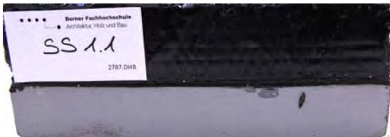
Abbildung 22: Prüfkörper aus Stahl mit PBD-Abdichtung
