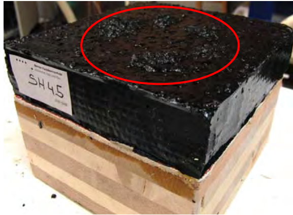
Abbildung 41: Prüfkörper aus Holz mit Blasenbildung
