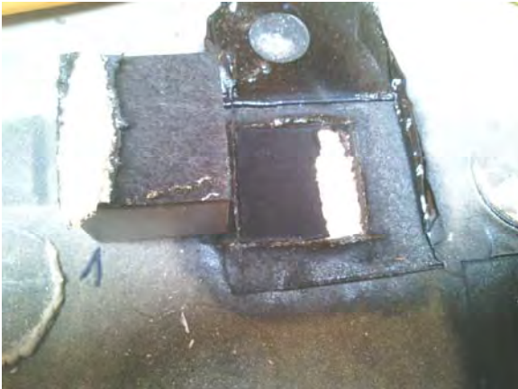
Abbildung 47: Probekörper mit PBD-Abdichtung nach bestandener Haftzugprüfung [9]
