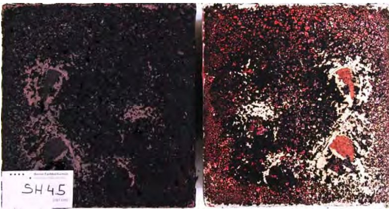
Abbildung 42: Geöffneter Prüfkörper mit deutlicher Blasenbildung
