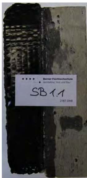
Abbildung 28: Verformter Prüfkörper aus Beton mit PBD-Abdichtung
