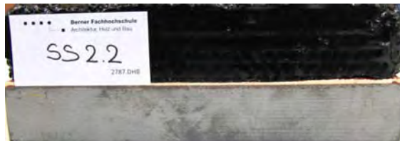
Abbildung 23: Prüfkörper aus Stahl mit FLK-Abdichtung
