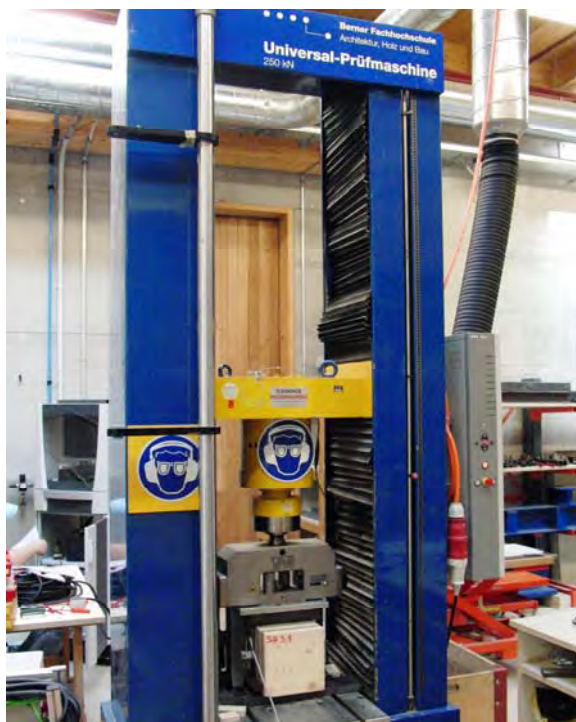
Abbildung 18: Eingerichtete Prüfmaschine (Schenk, 250 kN) zur Scherprüfung
