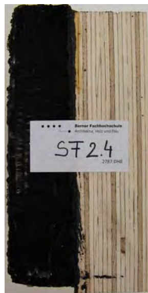
Abbildung 29: Verformter Prüfkörper aus Furnierschichtholz mit PBD-Abdichtung
