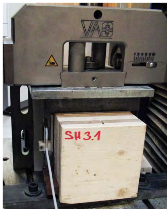
Abbildung 19: Eingerichtete Prüfmaschine zur Scherprüfung, Detail
