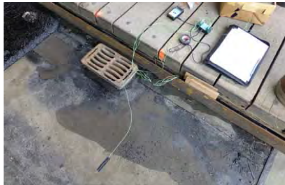
Abbildung 15: Temperaturmessung an der Bubeneibrücke
