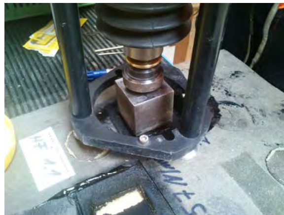
Abbildung 45: Mobiles Haftzugprüfgerät der Fa. BTS Baucontrol
