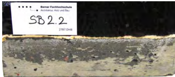
Abbildung 21: Prüfkörper aus Beton mit FLK-Abdichtung
