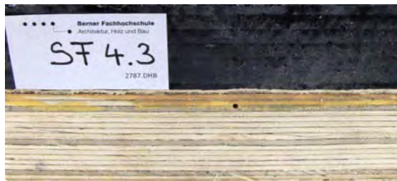
Abbildung 27: Prüfkörper aus Furnierschichtholz mit FLK-Abdichtung
