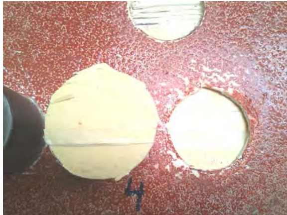
Abbildung 48: Probekörper mit FLK-PMMA-Abdichtung nach bestandener Haftzugprüfung [9]
