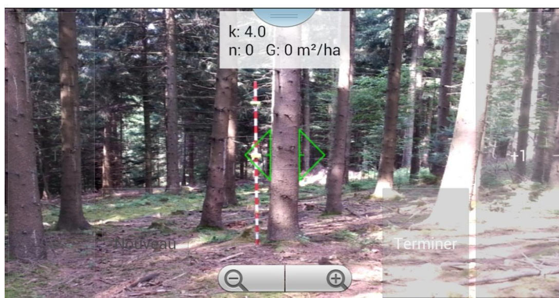
Fig. 42 : Exemple de capture d'écran faite lors des tests de la mesure de la surface terrière à l'ha. L'arbre de DHP 26 cm est visé à une hauteur de 1.30 m au dessus du sol indiquée par la marque jaune fixée sur le jalon. Dans cet exemple, on a utilisé le facteur de comptage k = 4 et le deuxième niveau de zoom.
