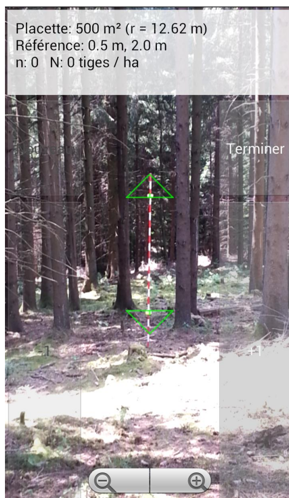
Fig. 43 : Exemple de capture d'écran faite lors des tests de la mesure du nombre de tiges l'ha. Dans cet exemple, l'intervalle de référence est de 1.5 m et on a utilisé le deuxième niveau de zoom. Le smartphone se trouve à une distance horizontale de 12.62 m du jalon ce qui correspond au rayon d'une placette circulaire de 500 m².
