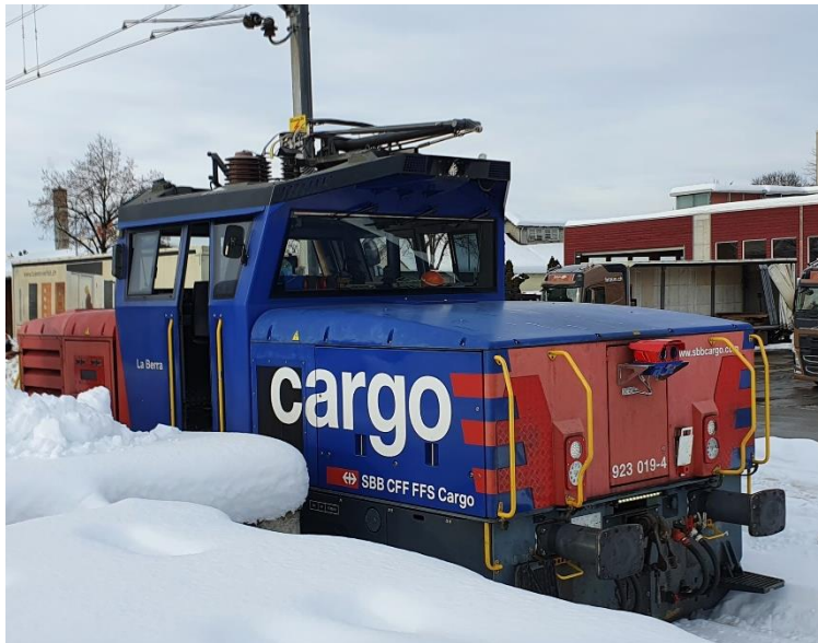
Abbildung 8: Wintertest der unbesetzten Spitze in Gossau.
