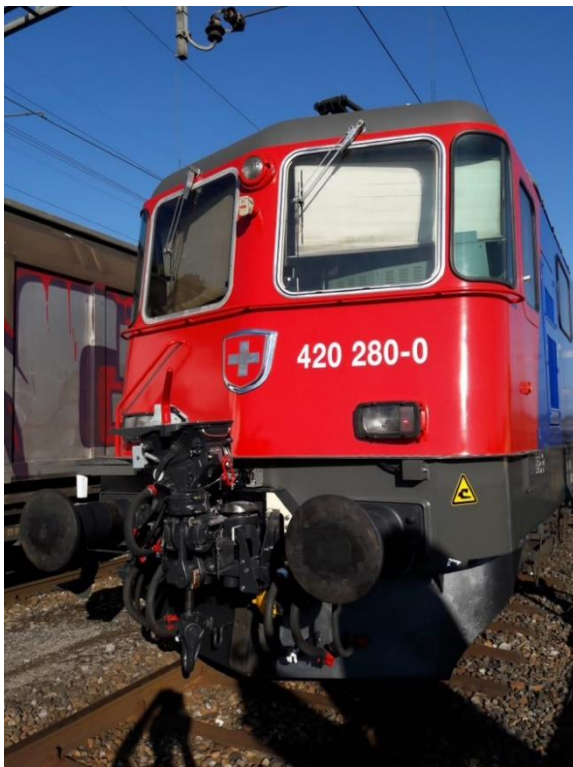
Abbildung 3: Re420 mit Hybridkupplung.
