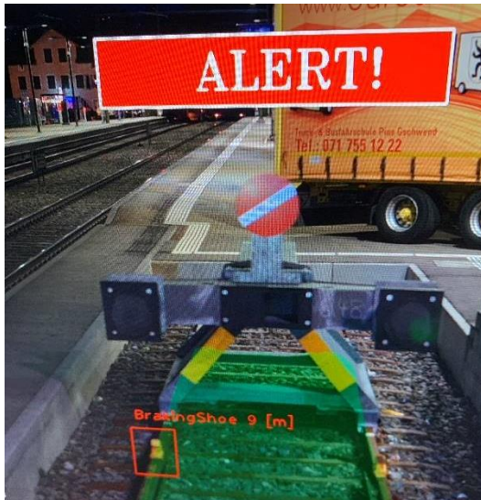
Abbildung 10: Vom Objekterkennungssystem erkannter Hemmschuh und Gleisabschluss.
