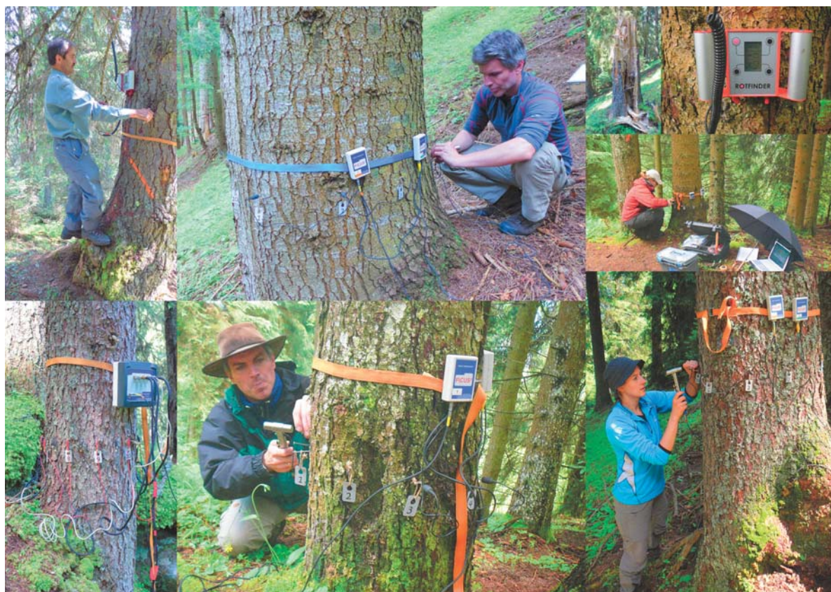
Abb. 1: Feldarbeiten Juni/Juli 2013. Von oben links, im Uhrzeigersinn: Dieter Trummer am Rotfinder (Zusatzmessung), Jan Wunder am PiCUS-Schalltomograph, Windbruch bei Riein, Rotfinder-Messgerät, Veronique Ringwald mit PiCUS-Tomographen-Ausrüstung, PiCUS-Widerstandstomograph, Jan Wunder und Anna Plotzki bei der Arbeit mit dem Schallhammer (PiCUS-Schalltomograph).
