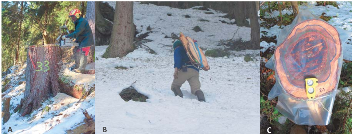
Abb. 2: Feldarbeiten im Herbst 2013. A Entnahme der Stammscheiben entlang der Messebene (Dieter Trummer, Danis GR). B Transport der Stammscheiben zur Waldstrasse (Jan Wunder, Vals GR). C Markierung der Fäulnisstellen nach Zersetzungsgrad (Breil GR).
