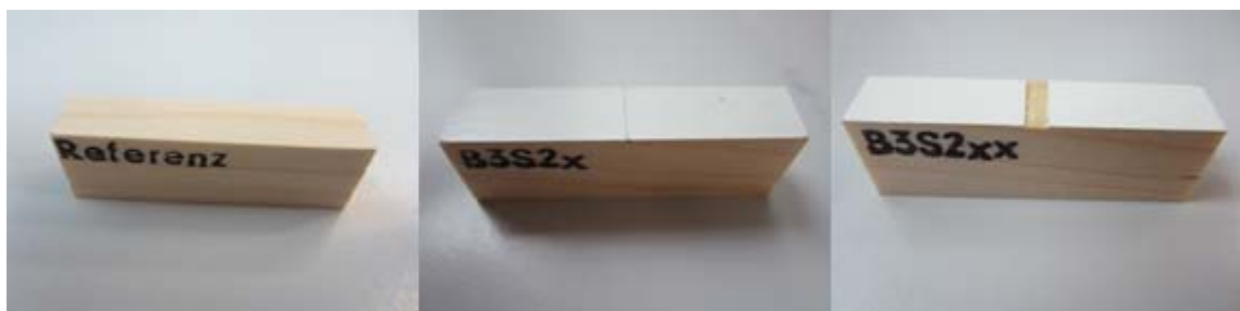
Abbildung 3.2: Links Refrenzprobe, Mitte Klingenschnitt, rechts Sägeschnitt
