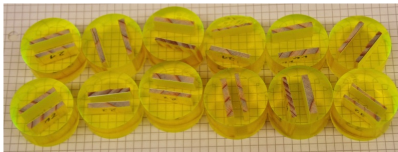
Abbildung 4.1: Proben für Mikroskopie
