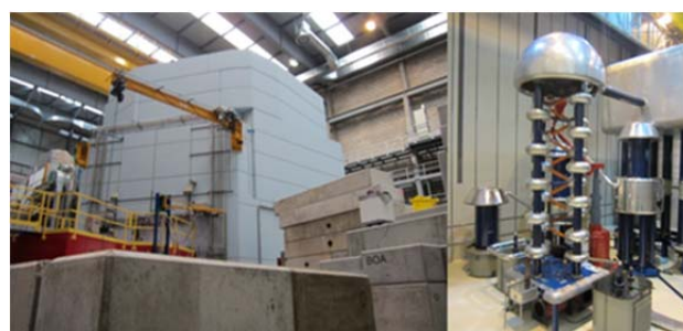
Abbildung 2.19: Links Cockroft-Walton-Beschleuniger, rechts Spallationsquelle SINQ
