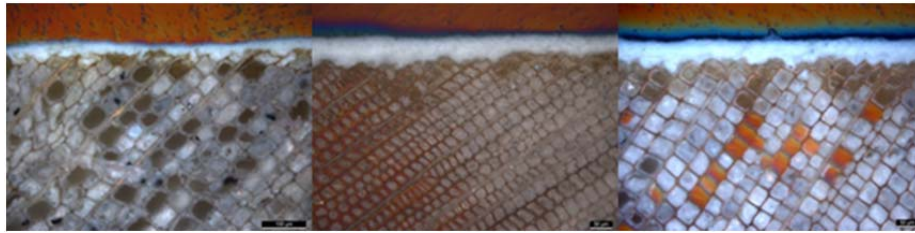
Abbildung 5.1: Beschichtungssystem 1 (v.l.n.r. 26µm, 52 µm, 55 µm)
