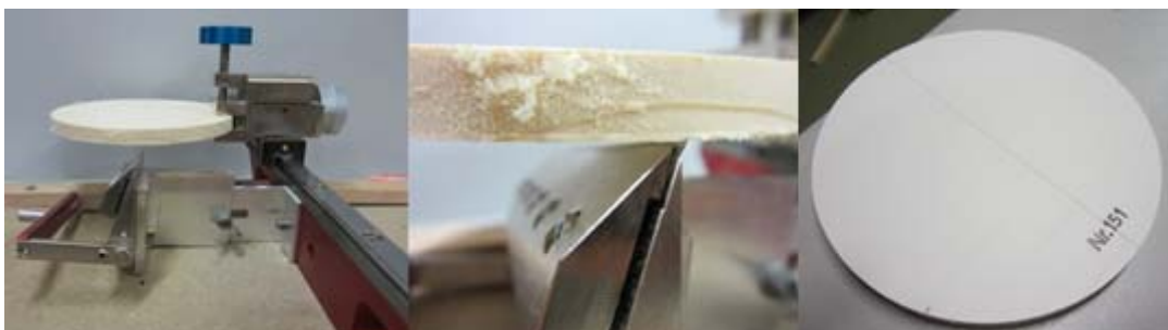
Abbildung 3.1: V.l.n.r. Schlittenmikrotom, Detail, Klingenschnitt
