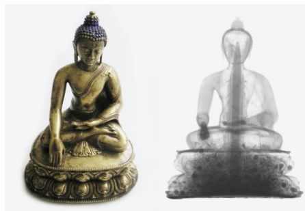
Abbildung 2.15: Links Messingstatue, rechts mit Neutronen erzeugtes Schattenbild (Paul Scherer Institut)
