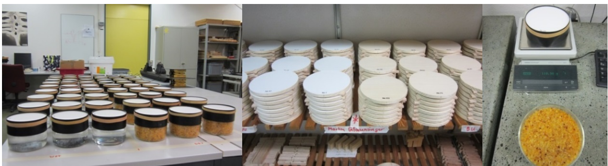
Abbildung 4.6: V.l.n.r. Wet- und Dry-Cup, Proben im Normalklima, Bestimmung der Masseabnahme der Probe bei Dry-Cup
