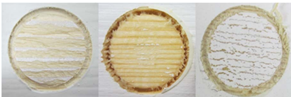
Abbildung 5.41: Bruchbilder bei Nasshaftfestigkeitsversuchen
