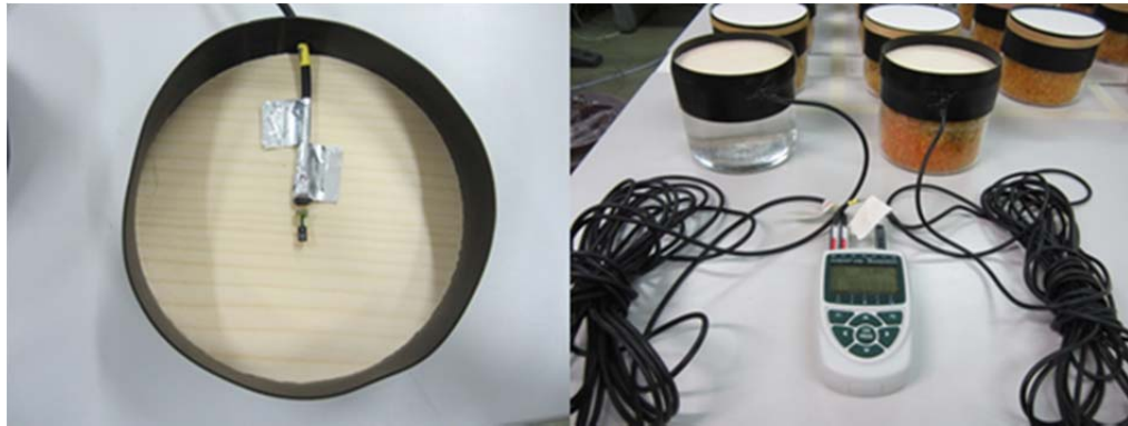
Abbildung 4.7: Luftfeuchtemessung in Dry- und Wet-Cup
