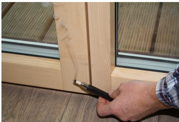
Abbildung 5.8: Mittels Rauch können grössere Leckagen gefunden und sichtbar gemacht werden.
