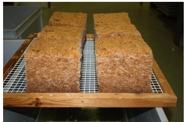
Abbildung 5.15: Abtropfen der Prüfkörper, um den Zustand der freien Wassersättigung zu erreichen.
