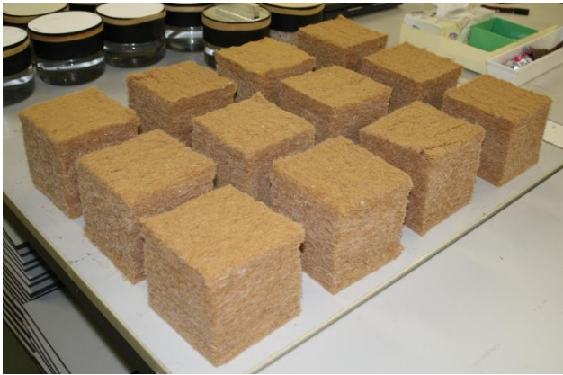
Abbildung 5.12: Zugeschnittene Prüfkörper in Würfelform mit einer Kantenlänge von 120 mm.
