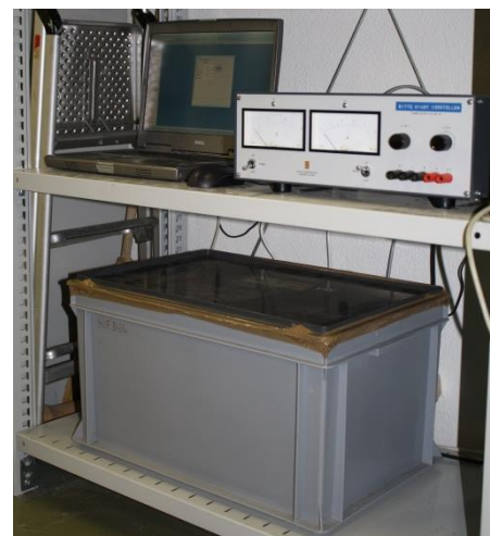
Abbildung 4.6: Installierte Klimabox mit Laptop [8] für die kontinuierliche Gewichtsabnahme.
