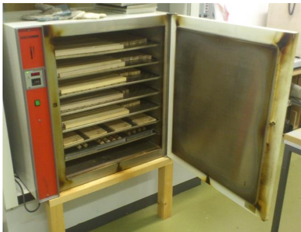
Abbildung 3.11: Darrvorgang bei 103\text{ °C} \pm 3\text{ °C} .
