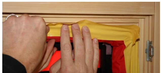
Abbildung 5.6: Abkleben der Fuge zwischen dem Rahmen der Apparatur und dem Rahmen der Aussentür.
