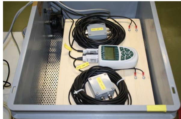
Abbildung 4.9: Der Prüfkörper und die darauf liegenden Holzfeuchtesonden [5], inklusive Universalmessgerät [6] liegen auf der Waage [3].
