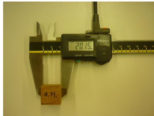
Abbildung 3.12: Massabnahme der Proben nach dem Darrtrocknen.
