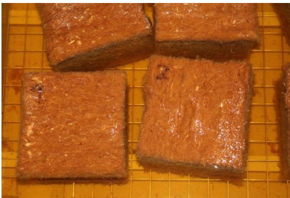
Abbildung 5.14: Prüfkörper komplett im Wasser eingetaucht.
