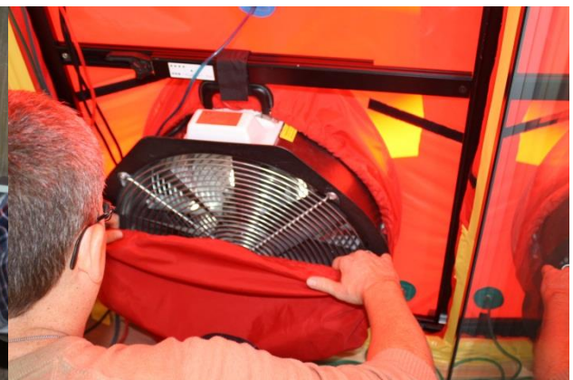
Abbildung 5.9: Verschliessen der Luftfördereinrichtung mittels Verschlusskappe.
