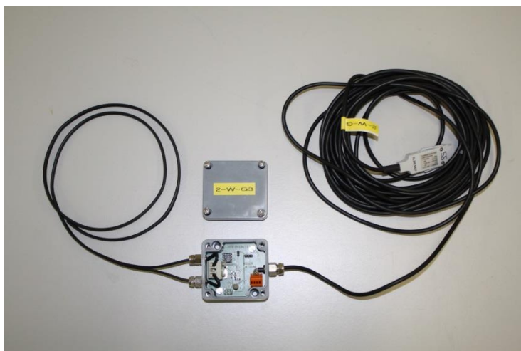
Abbildung 4.5: Holzfeuchtesonden für Langzeitmessungen FHA 636 MF10 des Herstellers Ahlborn [5].
