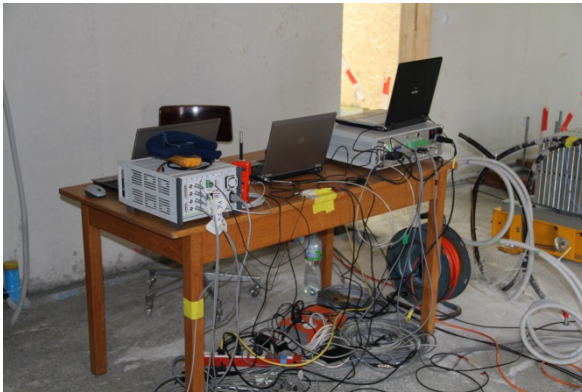
Abbildung 5.38: Kontroll-Ausrüstung zur Steuerung des Schwingungserregers (rechts) und zur Überwachung der Stockwerksverschiebungen (links).
