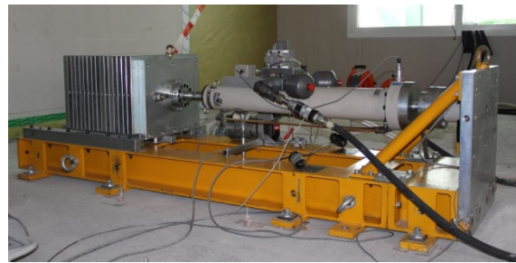
Abbildung 5.6: Horizontal-Schwingungserreger im Bauwerk eingebaut und mit der maximalen Masse von m_{\max} = 940 \text{ kg} betrieben.
