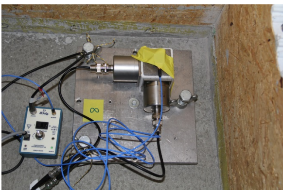
Abbildung 5.28: Messstelle Nr. 8 (OG 2) mit montierten Beschleunigungssensoren PCB 393B31 (horizontal) und PCB 3701G3FA3G (vertikal)
