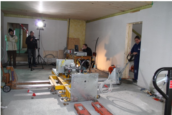
Abbildung 5.19: Anheben des Schwingungserregers an seitlich angeschraubten Konsolen mit 2 quer zur Schwingungserregerachse positionierten Handhubwagen.
