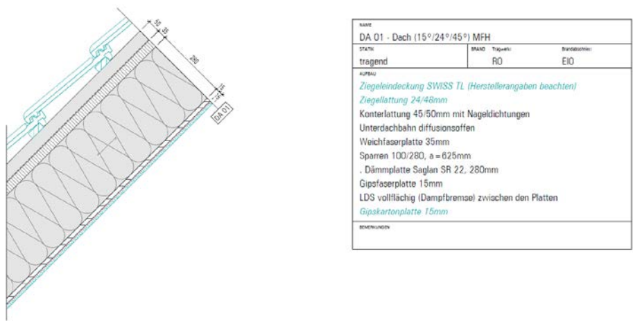
Abbildung 3.6: Sparrendach mit Ziegeleindeckung (Bild: Pirmin Jung AG)
