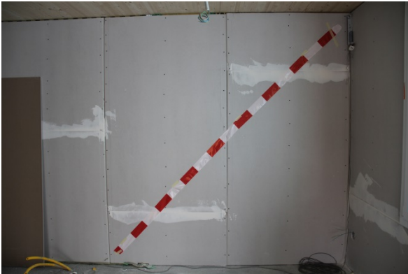
Abbildung 5.40: Messung der differentiellen Stockwerksverschiebungen
