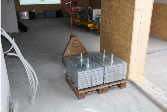
Abbildung 5.17: Entfernen der Stahlplatten (800 kg Zusatzmasse) vom Schlitten des Schwingungserregers.
