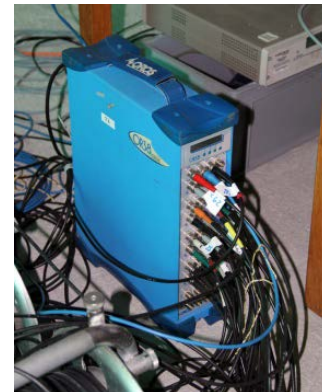
Abbildung 5.33: Datenerfassungsgerät Oros OR 38.
