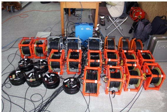
Abbildung 5.32: BNC-Kabel zur Verbindung der Sensoren mit dem Datenerfassungsgerät.
