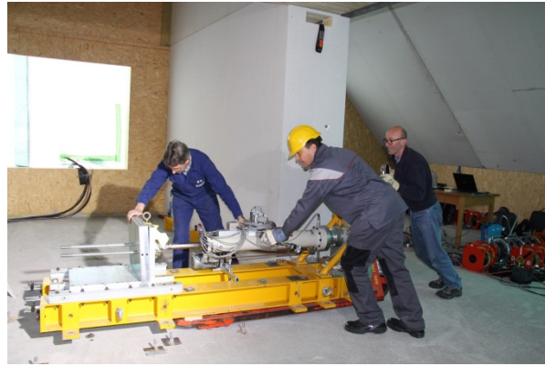
Abbildung 5.12: Verschieben des Schwingungserregers mit dem Handhubwagen zum Anregungspunkt.
