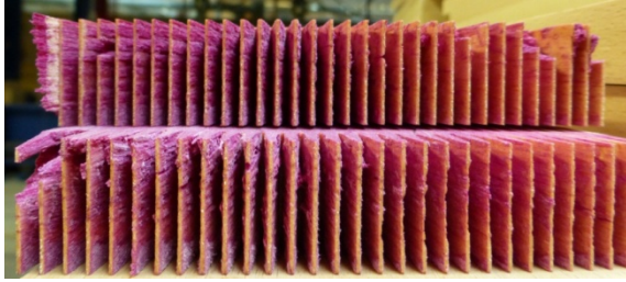
Abbildung 55: Prüfkörper mittels Wiesner-Test analysiert (Lignin färbt sich hell-rot), Serie 1-3
