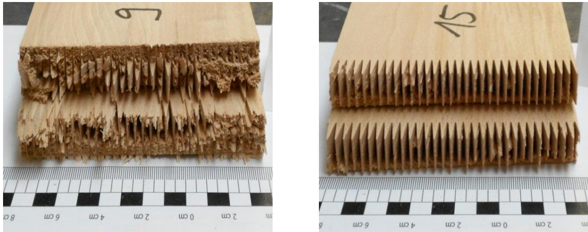
Abbildung 57: Typische Bruchbilder während der Flachkant-Biegeprüfung, Prüfkörper mit Holzversagen im Zinkengrund (links) und Prüfkörper mit Keilzinkenversagen entlang der Zinkenflanken in Zugzone (rechts)
