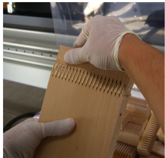
Abbildung 47: Klebstoffauftrag (links: Raupe, rechts: mittels Kamm)
