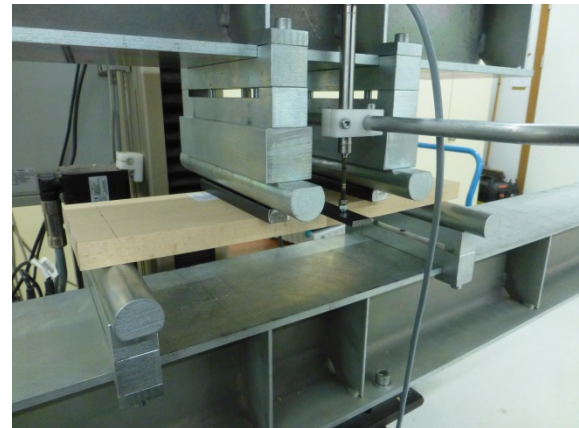
Abbildung 51: Prüfmaschine und Versuchsaufbau für Biegeprüfung
