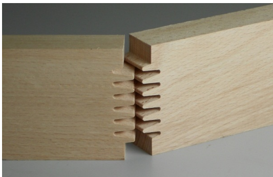
Abbildung 37: Keilzinkenprofil für Fensterkanteln, 10 mm Zinkenlänge
