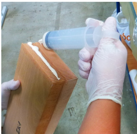
Abbildung 47: Klebstoffauftrag (links: Raupe, rechts: mittels Kamm)
