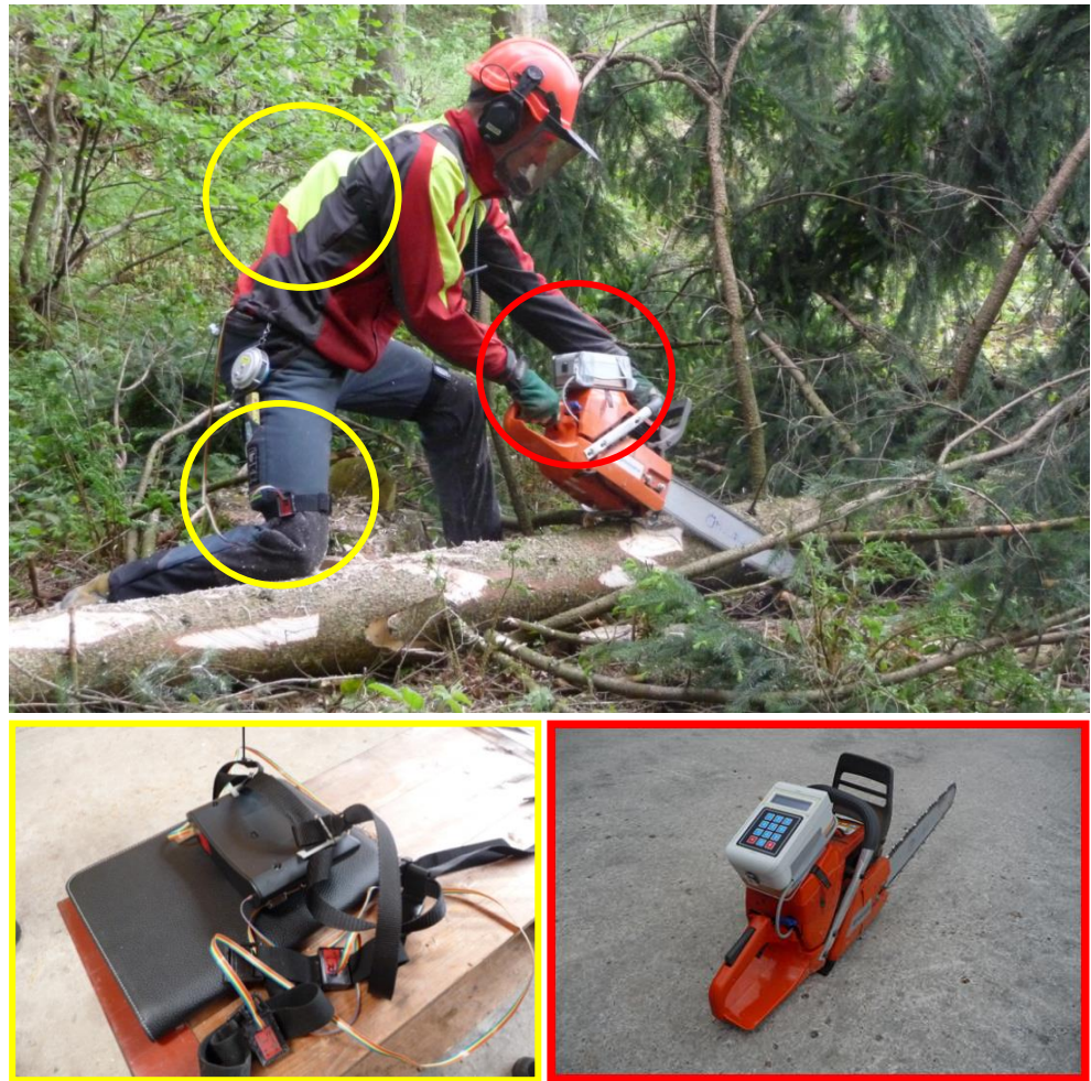
Abb. 1 Das Messsystem im praktischen Einsatz (gelb = Arbeitermodul, rot = Motorsägenmodul)
