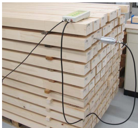
Image 1: mesure du module d'élasticité avec le Sylvatest
