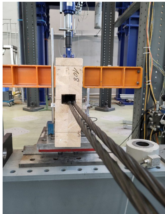
Abb. 33: Fräsung zum Verlegen der Vorspannung (Quelle: Muster, ETHZ 2022)
