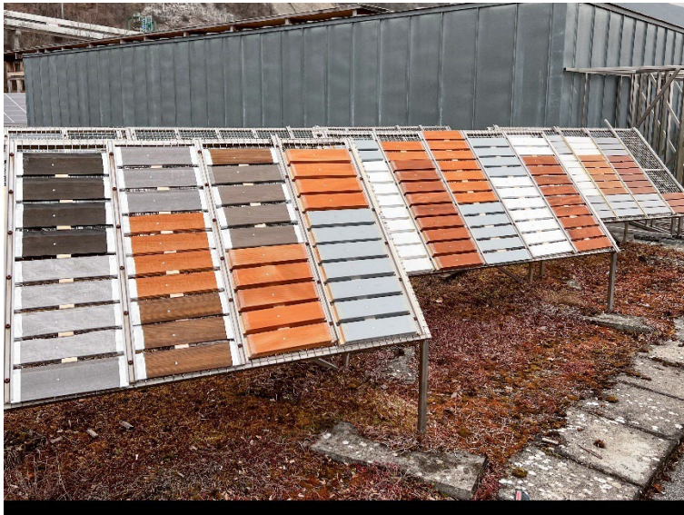
Abbildung 12 Bewitterungsstand der BFH nach EN 927-3 mit den Beschichtungsproben
