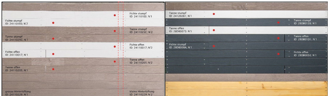
Abbildung 9: Fassadenelemente 1 (links) und 2 (rechts) ausgestattet mit Feuchtesensoren, deren Lage jeweils mit einem roten Punkt markiert ist. Die Leiste direkt unter den Stößen ist durch die rot gestrichelte Linie im linken Element gekennzeichnet.
