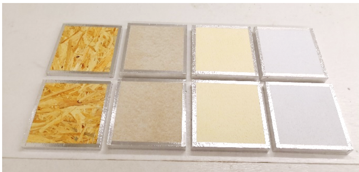
Abbildung 1: Zugeschnittene und für Emissionsprüfungen vorbereitete Prüfmuster. Links: OSB-Platte als Referenz, alle Weiteren: verschiedene Ausführungen mit dem Aufbau OSB-Platte/Gipsfaserplatte/Beschichtungssystem
