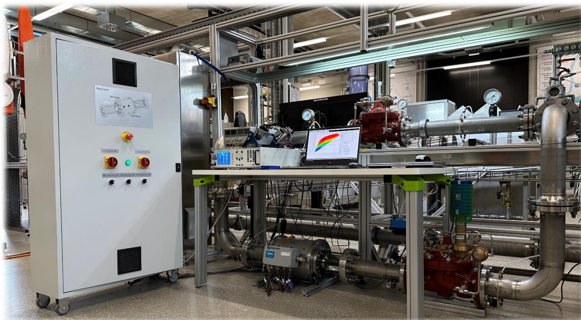
Figure 27 : Dispositif de test en laboratoire avec la turbine, ses génératrices, son armoire de commande, et les deux vannes de régulation installées sur le banc d'essai de la HES-SO Valais.
