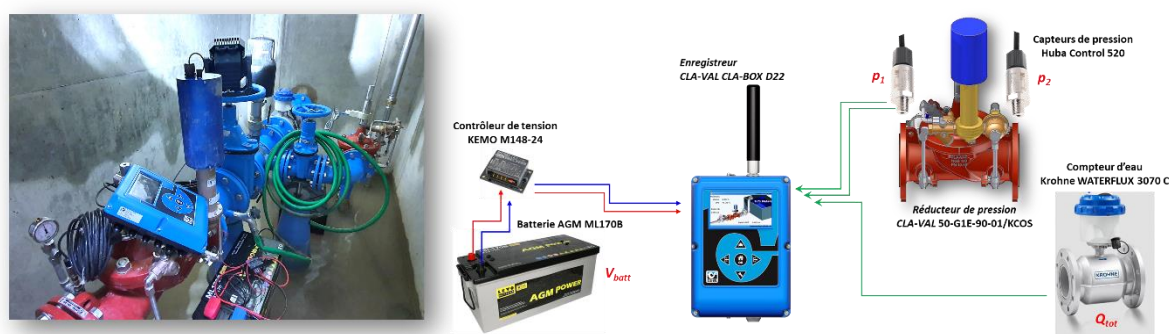
Figure 48 Architecture du système de mesure autonome déployé sur le site de Davel.
