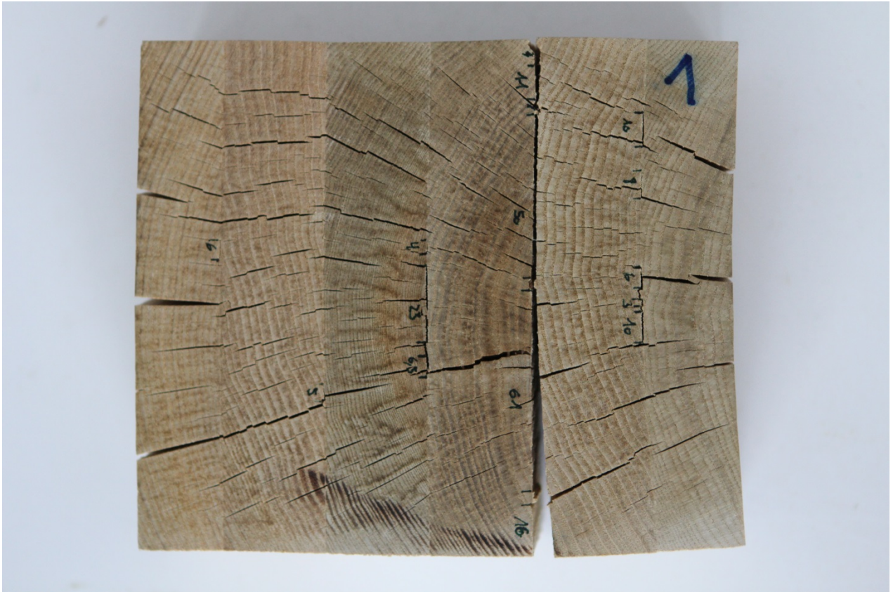
Abbildung 28: Delaminierungsprobe - Verfahren bei hoher Temperatur - MUF 5022
