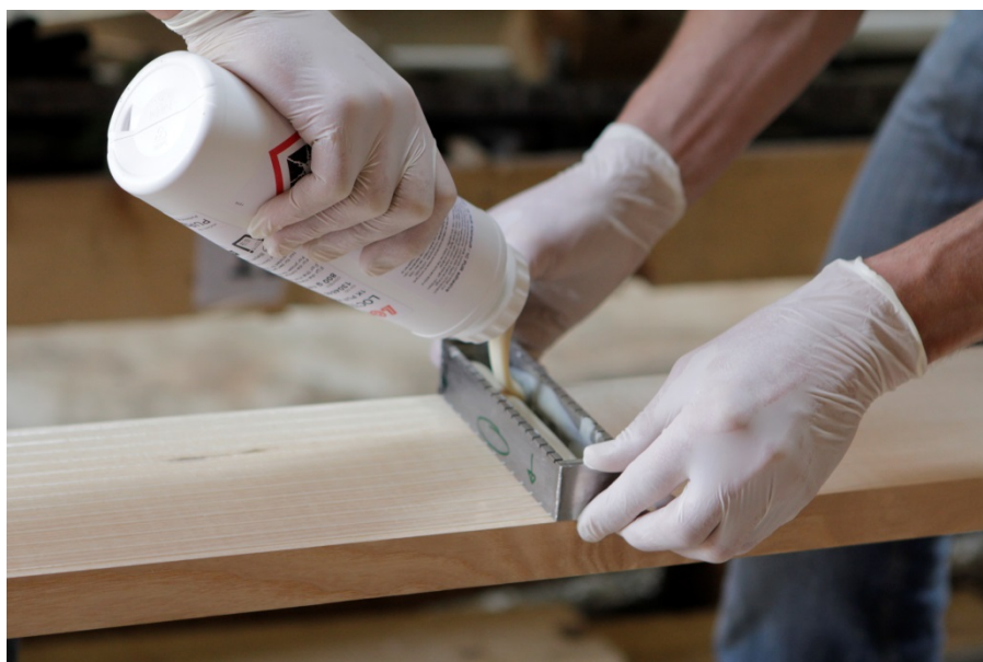
Abbildung 1: Klebstoff Applikation des PUR bei der Verklebung der Delaminierungsproben
