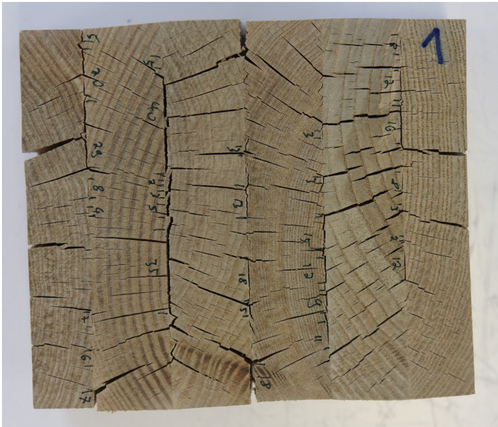
Abbildung 27: Delaminierungsprobe – Verfahren bei hoher Temperatur – MUF 5020
