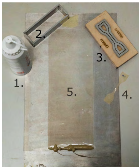
Figure 22: Processus de fabrication des adhésifs; 1. Colle PUR, 2. "Spatule" utilisée pour étaler l'adhésif sur la feuille de plastique, 3. Chablon utilisé pour découper la forme des échantillons, 4. Exemple d'un échantillon terminé, 5. Film d'adhésif après réticulation
