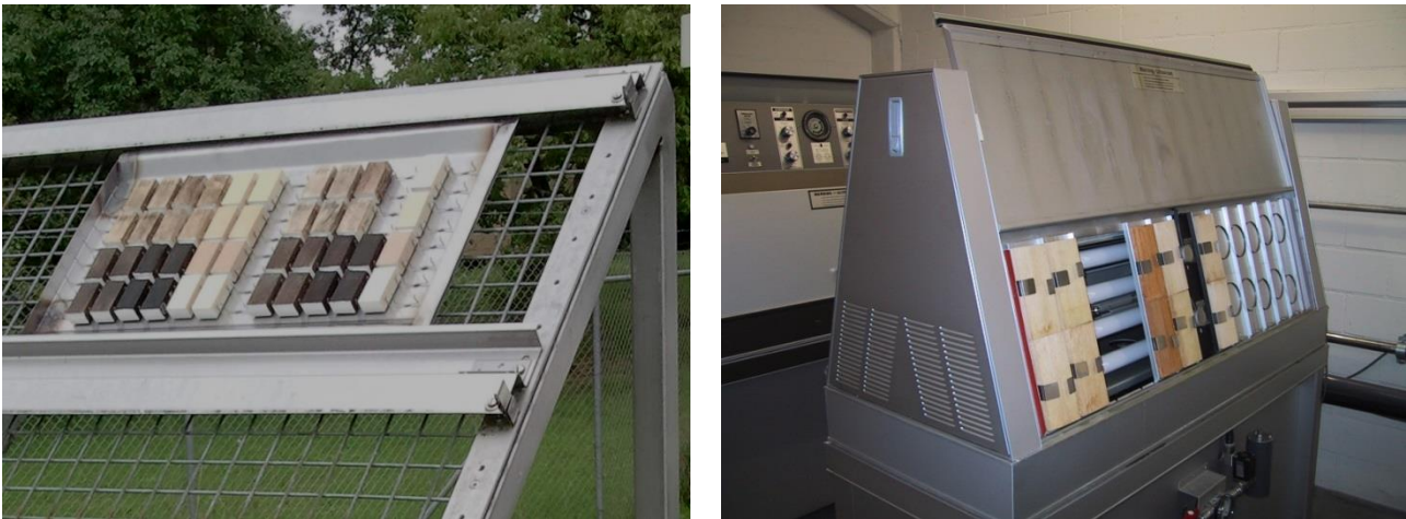
Bild 5: Natürliche Freibewitterung (links) und künstlicher Bewitterungsversuch mit QUV (rechts)
