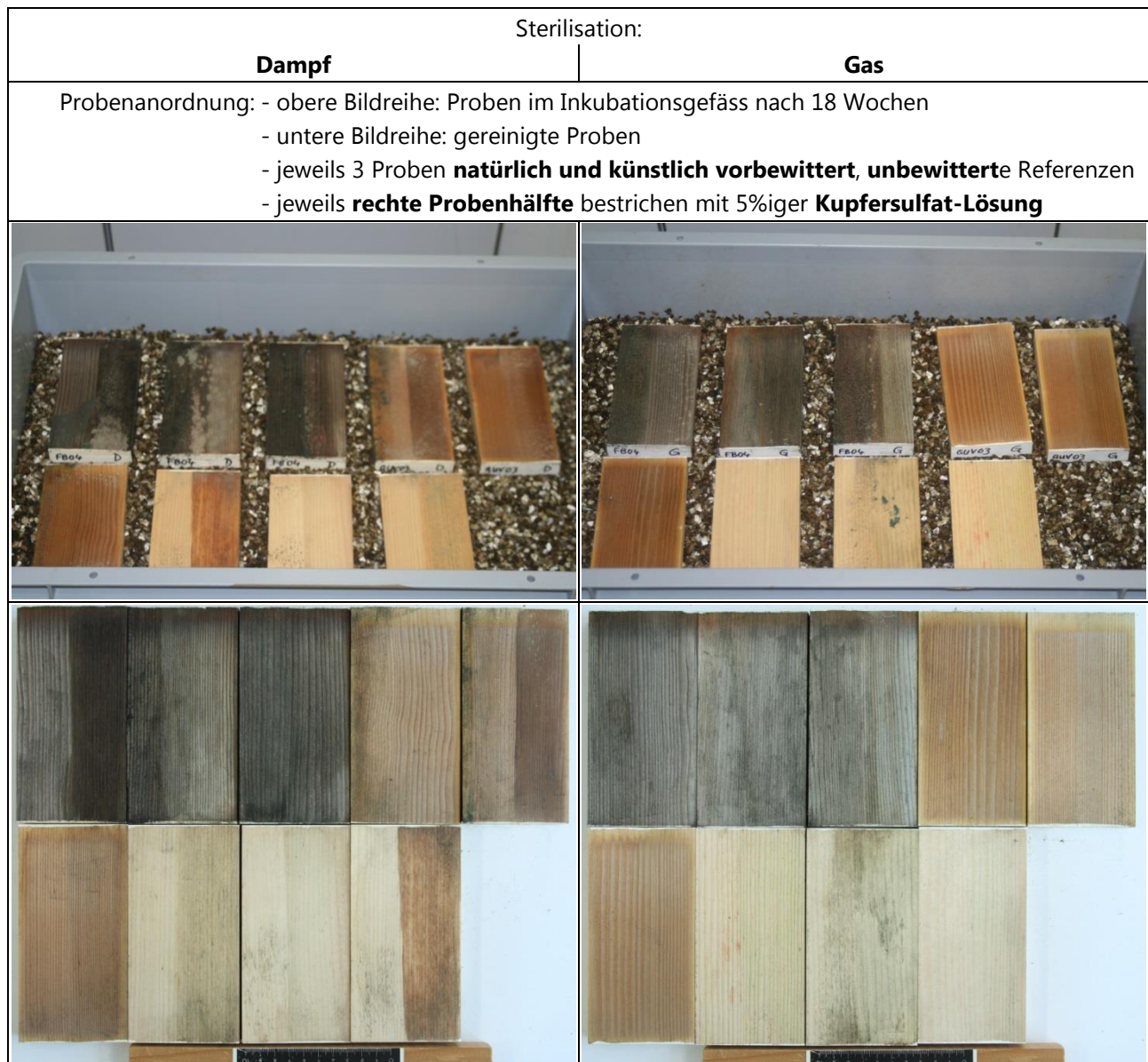
Bild 9: Pilzbewuchs und Melanisierungsgrad von Holzproben in Abhängigkeit von Vorbewitterung, Cu-Behandlung und Sterilisation (Serie 2: Fichte, Mischsuspension D. fissa/loculata , auf Vermiculit)
