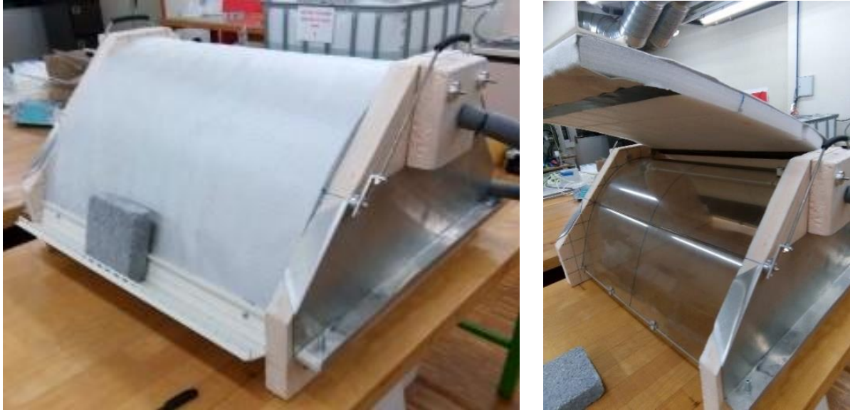
Figure 10.8 : Isolation temporaire limitant la déperdition thermique de la Maquette lors de son chargement
