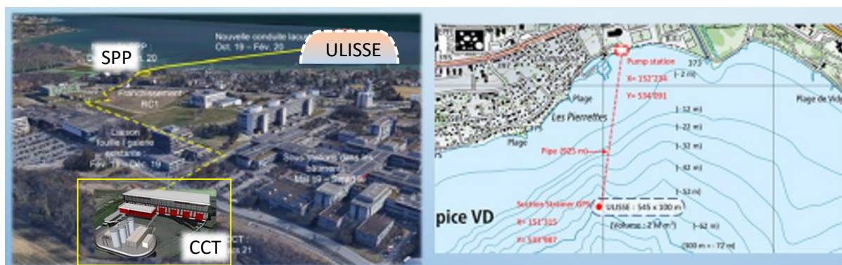
Figures 11.1 : Proposition d'implantation dans le Léman et de raccordement du pilote ULISSE à l'infrastructure de chauffage et de refroidissement (SPP + CCT) de l'EPFL-UNIL, avec observation environnementale et physique par la plateforme LÉXPLORE.
