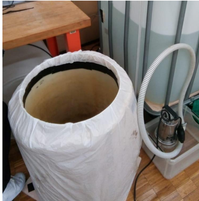
Figure 6 : Bidon de préparation d'eau chaude (isolation périphérique en laine de verre)
