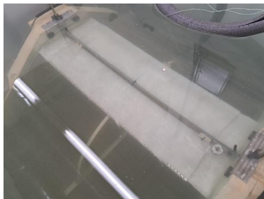
Figure 19 : Nappe de feutre sous la rampe d'injection dans la Maquette (répartiteur de flux d'injection d'eau)
