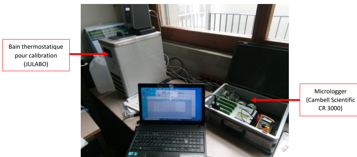
Figure 9.21 : Setup de calibration des thermocouples
