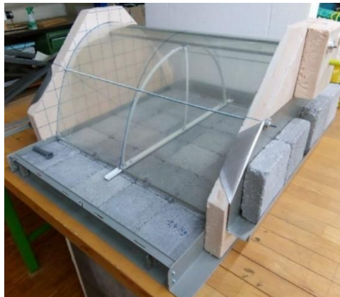
Figure 9.15 : Construction de la Maquette, support pour lestage, cadre des pavés en béton (fond lacustre)
