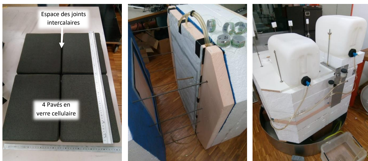
Figures 1 : Caisson de mesures de la conductance thermique et hydraulique de l'enveloppe du Réservoir ULISSE
