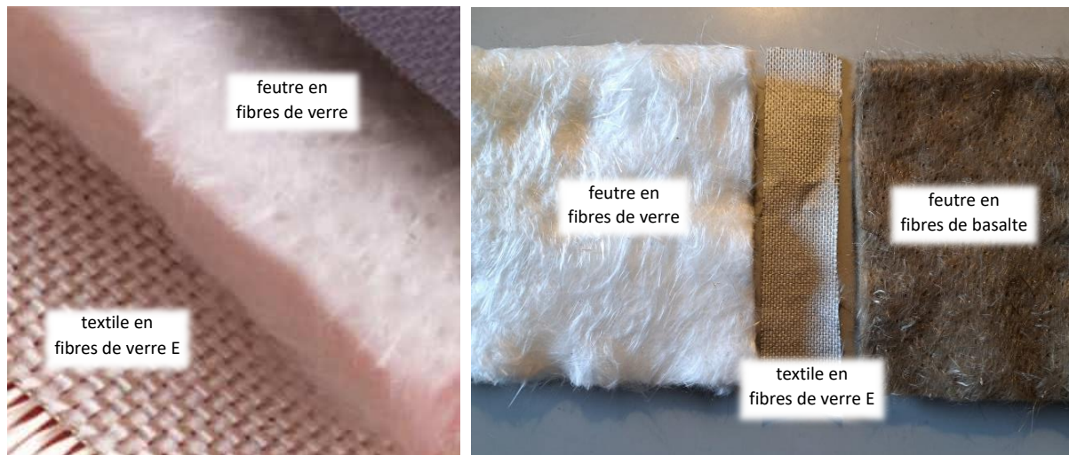
Figure 8. 4 : Textile et feutre en fibres de verre type E (photo final-materials.com), d. Fibres de verre et de basalte
