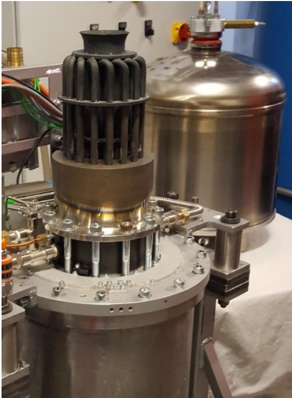
Abbildung 1: Der Prototyp SFM2, mit nebenstehendem Brenner, Quelle: Schmid Stirling GmbH, 2019
