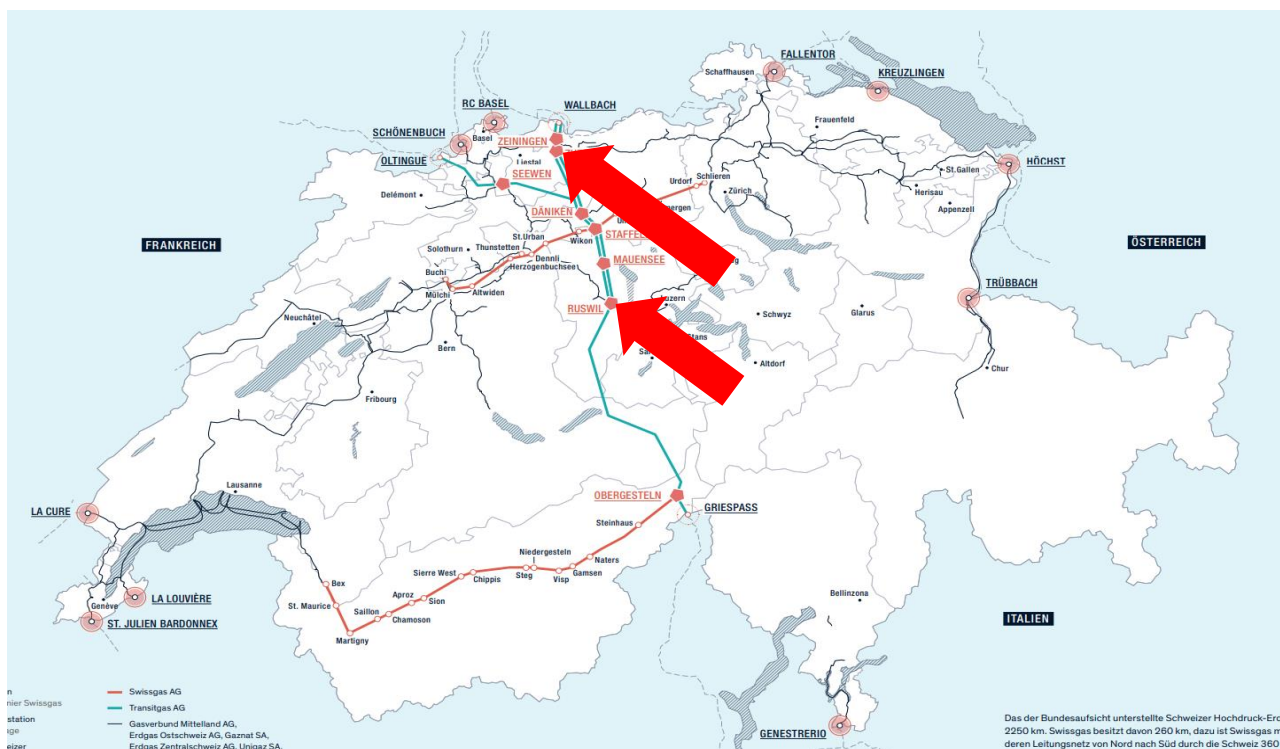
Figure 1 : Schéma du réseau suisse de gaz naturel, avec, indiqué par les flèches rouges, les 2 points de mesures continues aux postes frontières de Zuzgen et Ruswil (source : swissgas.ch)
