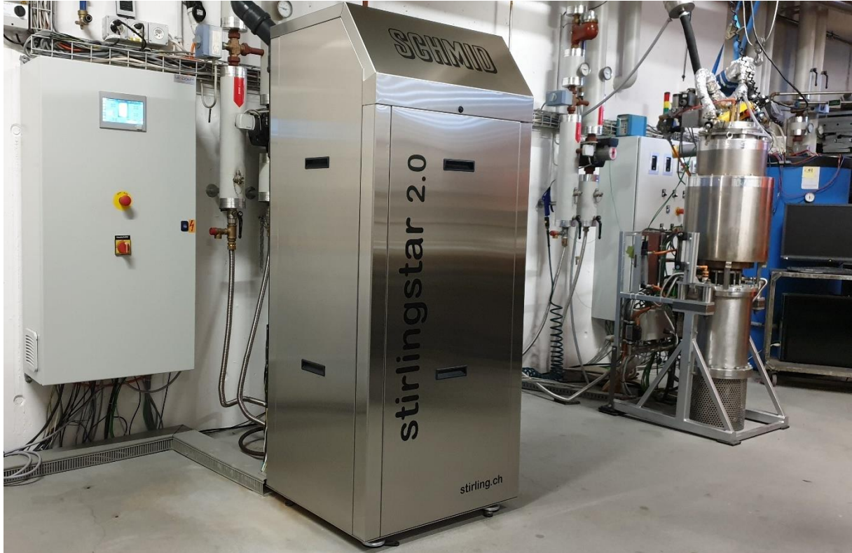
Abbildung 4: Der Freikolben-Resonanzstirling mit Gehäuse – Neben an die ältere Version SFM2, Quelle: Schmid Stirling GmbH, 2019
