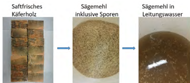
Abbildung 28 Herstellung der Suspension mit Bläuepilz-Sporen
