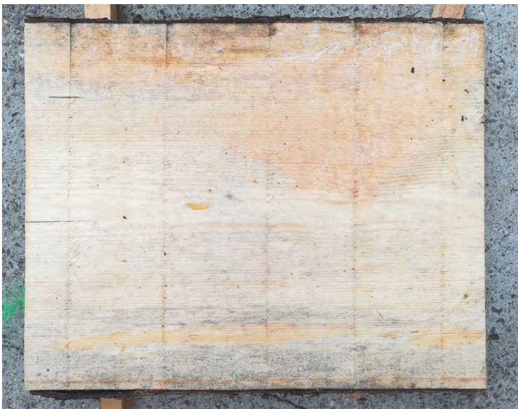
Abbildung 31 Fichtenbrett mit Bläue, Schimmel und Rotstreichigkeit nach künstlicher Verblauung
