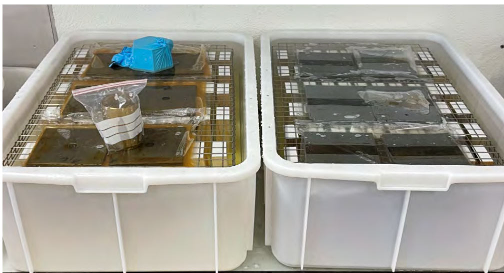
Abbildung 76 Tauchversuch zur Bestimmung der Wasseraufnahme über die Tangentialflächen
