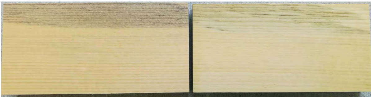
Abbildung 122 Unbehandelt (links) und nach Behandlung mit Natriumpercarbonat-Lösung (rechts)
