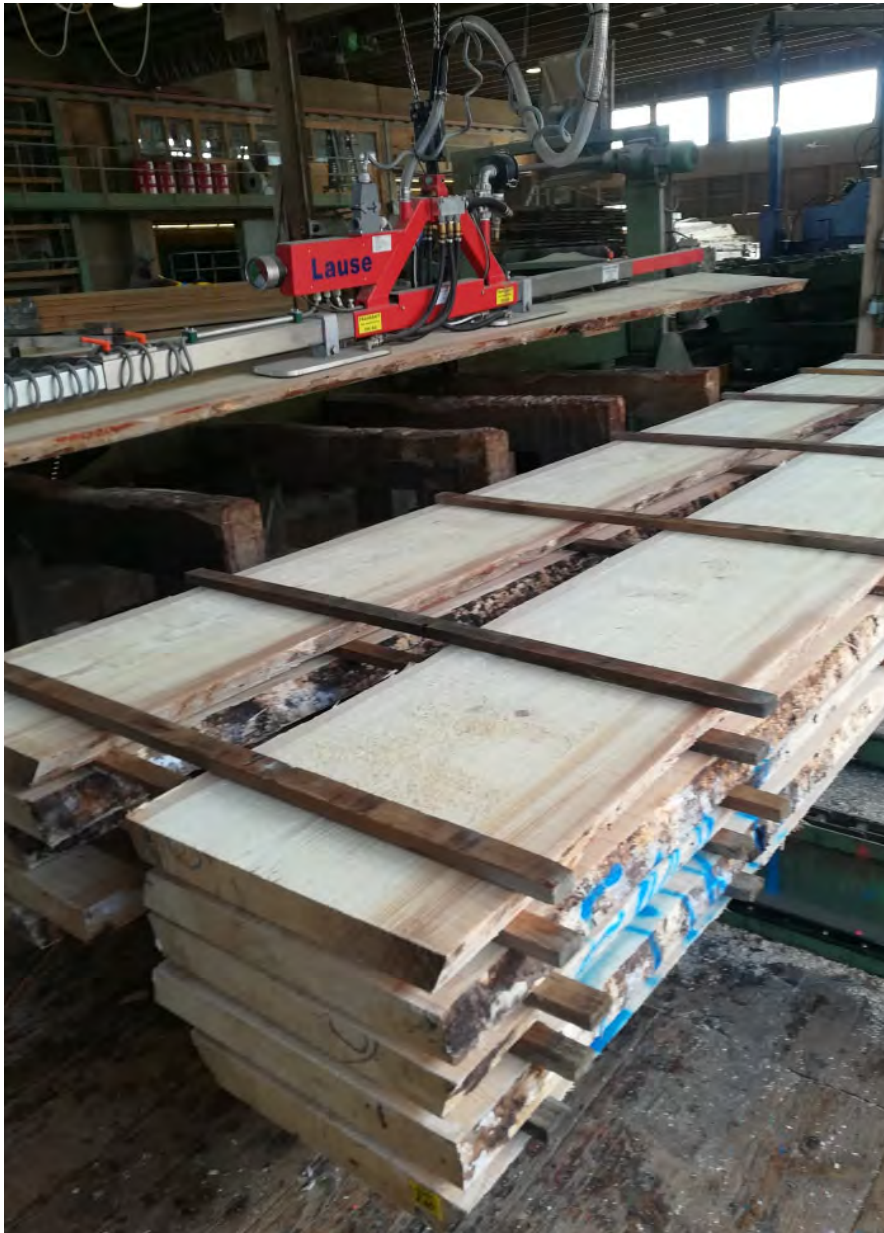
Abbildung 13 65 mm Bretter ohne Bläue als Referenz
