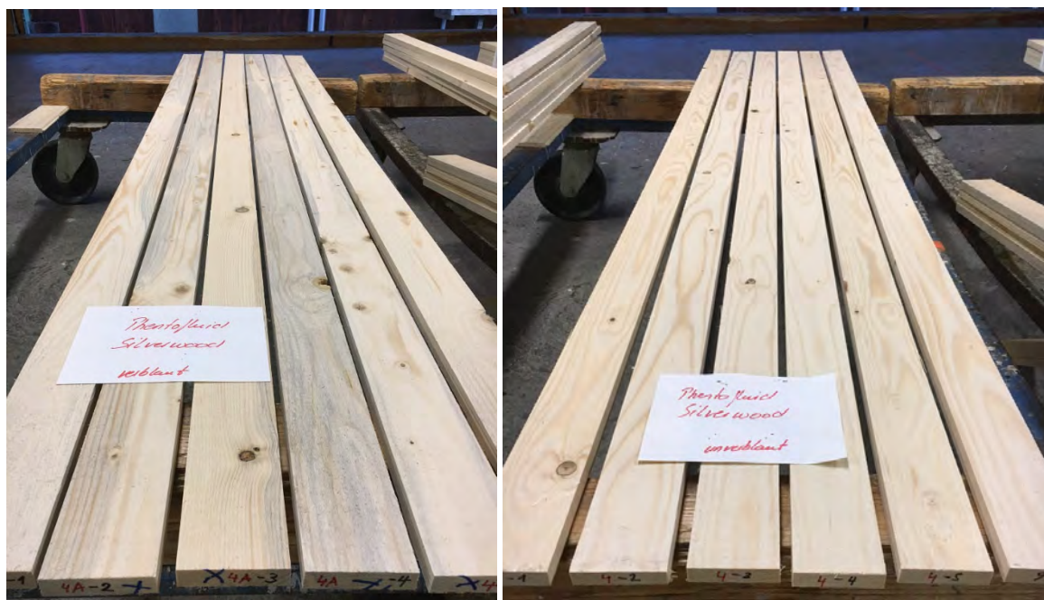
Abbildung 25 Bretter verblaut (links) und unverblaut (rechts) der Fa. OLWO AG
