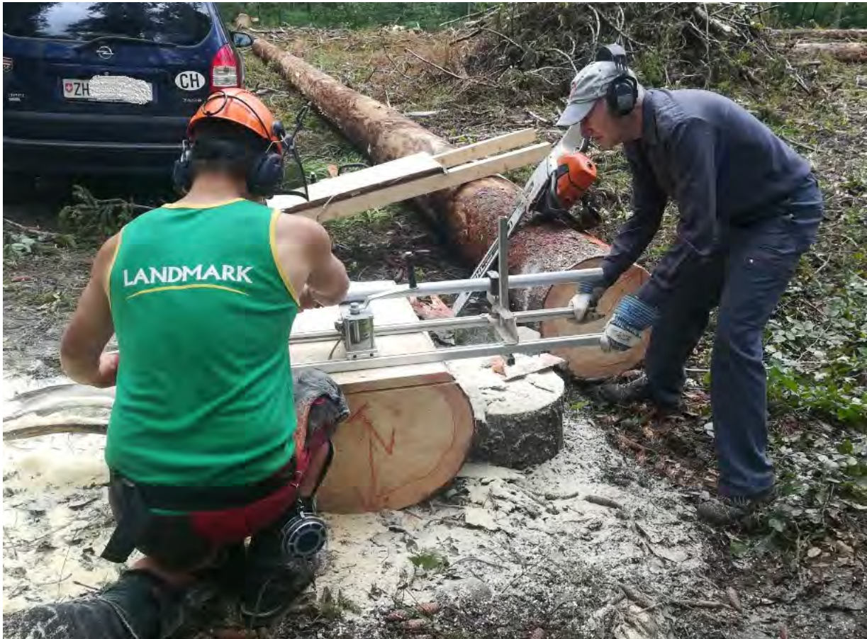
Abbildung 16 Einschnitt der Rugel zu Brettern direkt im Wald
