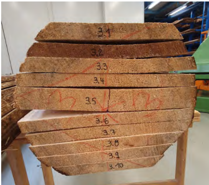
Abbildung 20 Technisch getrocknete Brettware aus Stamm 3 (Brett 3.2 gedämpft)
