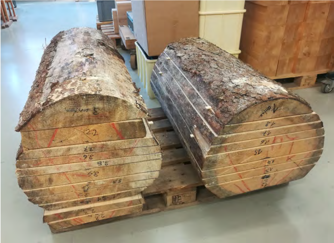
Abbildung 18 Lagerung an der Empa, welche kurzzeitig eine weitere Verblauung im Stamm begünstigte
