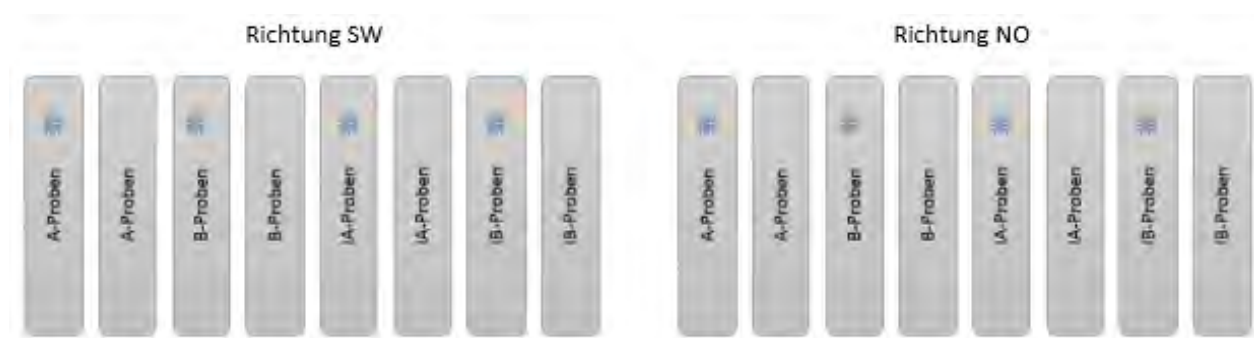
Abbildung 137 Beispiel Freibewitterungsproben pro Beschichtungssystem A- und B-Pröben aus Charge II (siehe Kap.6.1.1) IA- und IB-Pröben aus industrieller Fertigung (siehe Kap. 0) Vorschädigung (blaue Markierung)
