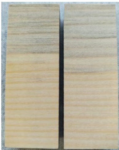
Abbildung 124 UV-LED-Lampe (links ohne; rechts nach 30 min)
