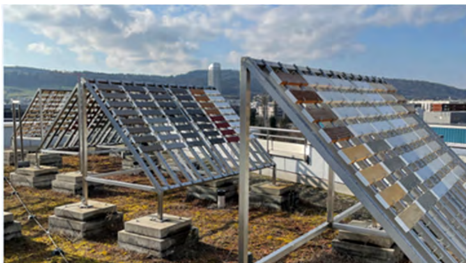
Abbildung 138 Freibewitterungsstand Empa Dübendorf
