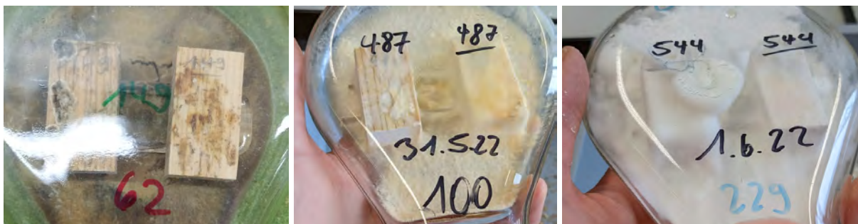
Abbildung 104 Kolleschalen mit Proben nach der 16-wöchigen Exposition; von links: Brauner Kellerschwamm, Balken-Blättling, Rosafarbener Saftporling; im Foto jeweils links: Prüfprobe aus verblautem Käferholz mit biozidfreier Beschichtung und versiegelten Hirnflächen (Original ohne Bewitterung) im Foto jeweils rechts: Kontrollprobe aus Fichte, komplett unbehandelt
