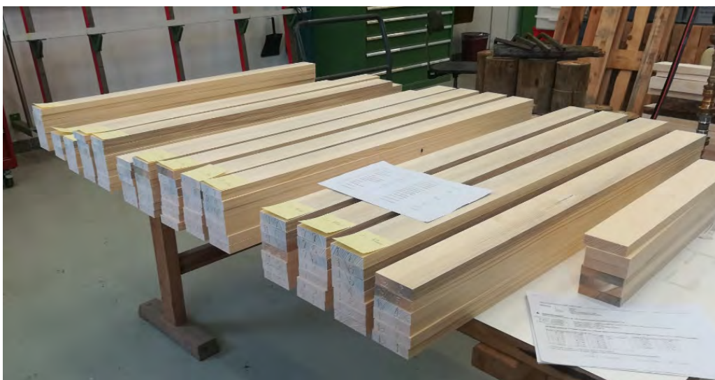
Abbildung 23 An der Empa zugeschnittene, gehobelte Lamellen für die industrielle Beschichtung
