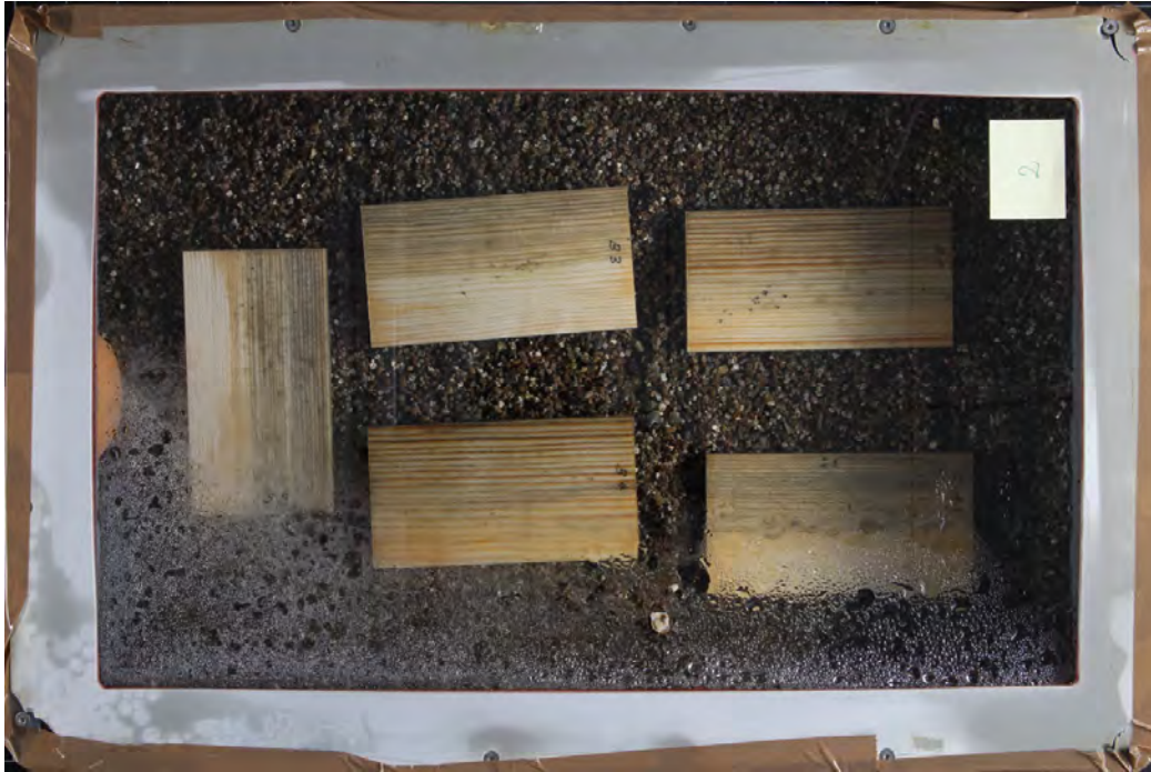
Abbildung 83 Proben der Gruppe 3 (B) nach 3 Wochen Lagerung im Klima 23°C/≈100% RH (Box 2)
