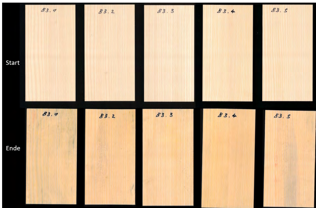
Abbildung 89 Ausbildung von Bläue an einigen der zuvor unverblauten Käferholz-Proben während der 12-wöchigen Lagerung in der feuchten Box
