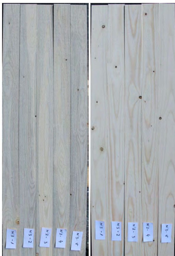
Abbildung 26 Bretter verblaut (links) und unverblaut (rechts) der Fa. Mivelaz Bois SA.
