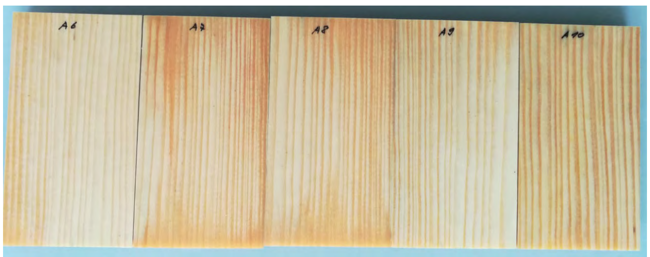
Abbildung 86 Referenz-Proben im feuchten Zustand direkt nach dem Versuch
