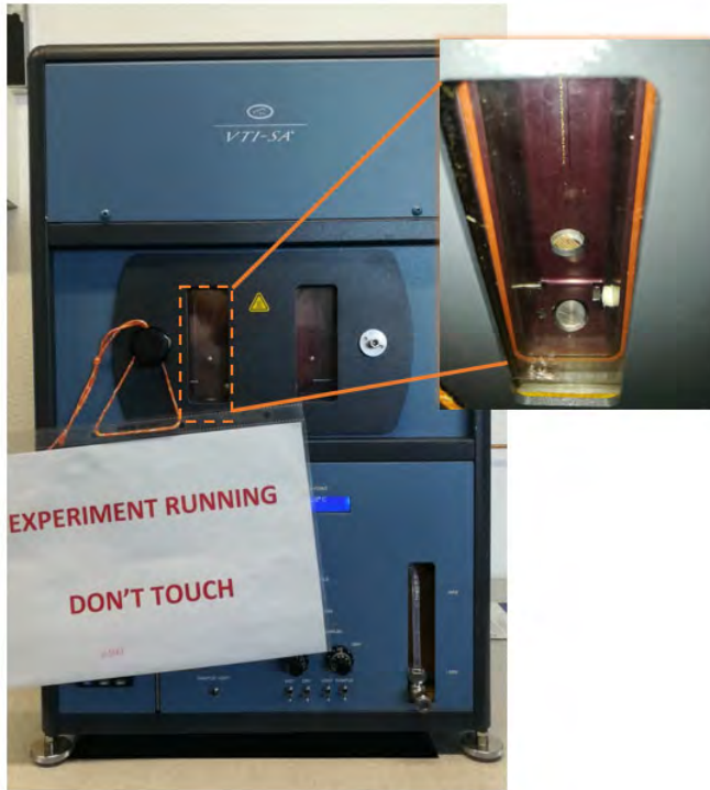
Abbildung 67 VTI-SA+ Dampfsorptionsmessgerät; Probenkammer mit Waagschale und Holzprobe
