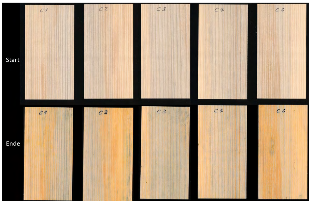
Abbildung 88 Proben vor und nach der 12-wöchigen Lagerung in der Box
