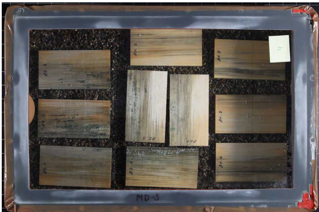
Abbildung 81 Verblaute Proben der Gruppe 2 (B1 technisch getrocknet, B2 luftgetrocknet) nach 1 Woche Lagerung im Klima 23°C/≈100% RH (Box 4)
