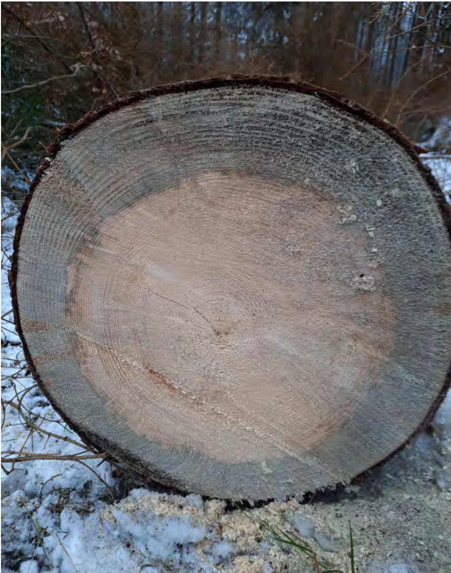
Abbildung 4 Frisch gefällte Fichte mit Borkenkäferbefall und starker primärer Bläue
