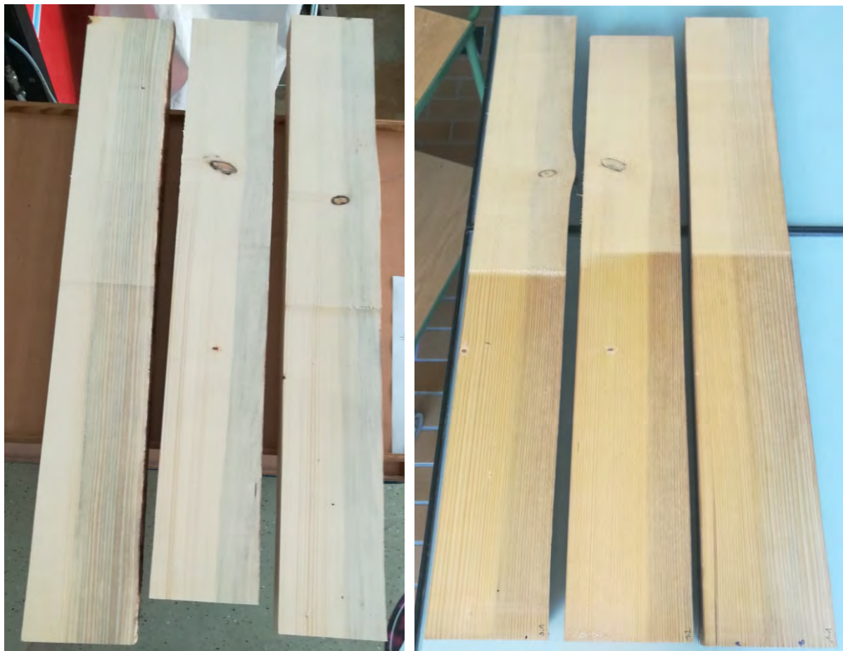
Abbildung 129 Bretter vor dem Dämpfen (links) und nach dem Dämpfen (rechts); oberer Bereich: feingesägt; unterer Bereich: gehobelt
