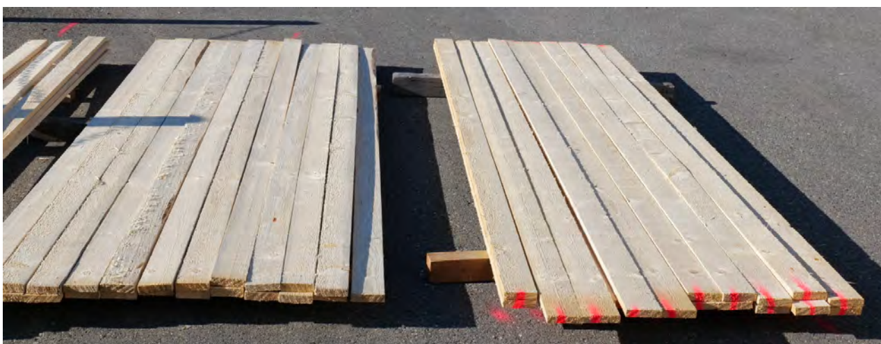
Abbildung 24 Bretter verblaut (links) und unverblaut (rechts) der Fa. Gebr.Eisenring AG
