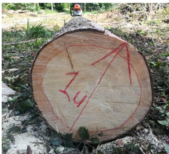
Abbildung 15 Stamm Nr.1 im oberen Teil verblaut (links) und im unteren Bereich noch unverfärbt (rechts)
