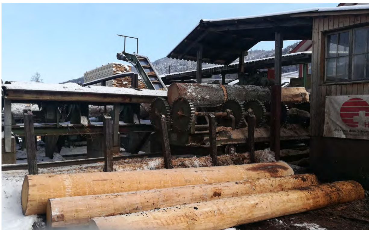
Abbildung 12 Entrindungsstation mit frisch entrindeten Fichtenstämmen
