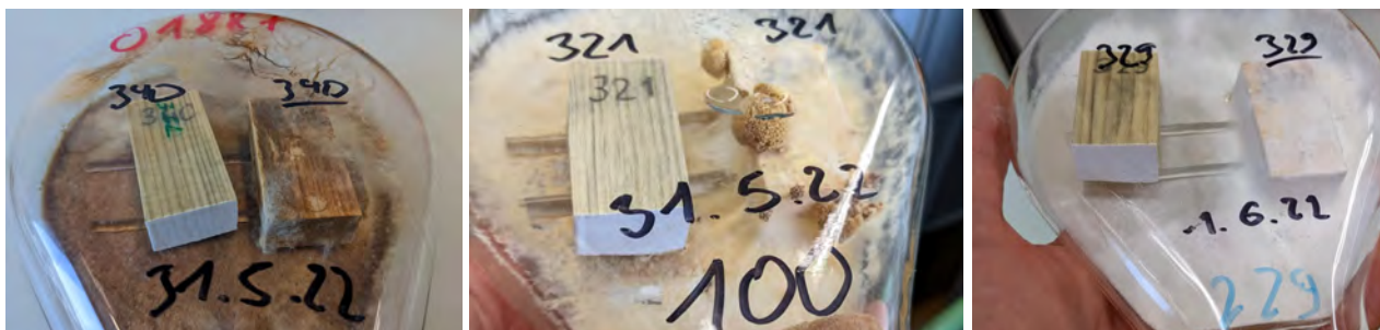
Abbildung 101 Kolleschalen mit Proben nach der 16-wöchigen Exposition; von links: Brauner Kellerschwamm, Balken-Blättling, Rosafarbener Saftporling; im Foto jeweils links: Prüfprobe aus verblautem Käferholz mit biozidhaltiger Öllasur und versiegelten Hirnflächen (Original ohne Bewitterung) im Foto jeweils rechts: Kontrollprobe aus Fichte, komplett unbehandelt
