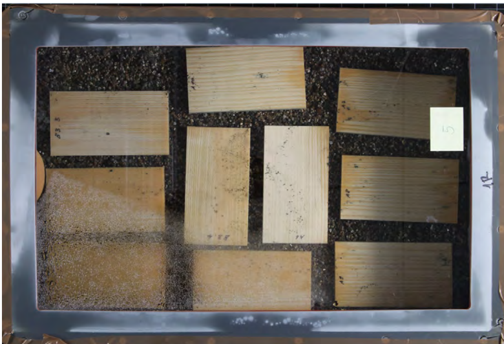
Abbildung 84 Unverblaute Käferholz-Proben (Gruppe 1,B3) und Referenz-Proben (A) nach 3 Wochen Lagerung im Klima 23°C/≈100% RH (Box 5)
