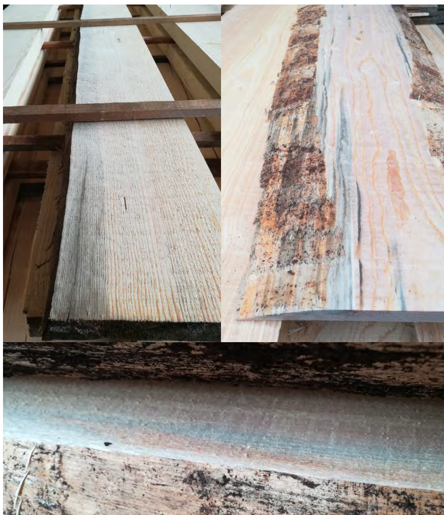
Abbildung 7 Brettware verblautes Käferholz Fichte mit bereits einsetzender Rotstreifigkeit
