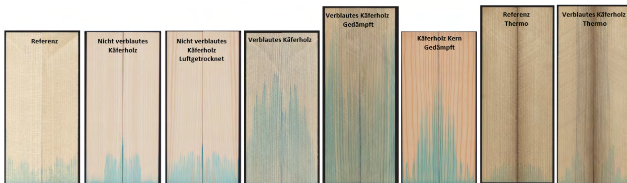
Abbildung 75 Beispiele für die durch kapillar eingesaugtes Wasser verfärbten Proben (von links: Referenz, Gruppe 1 techn. getrocknet, Gruppe 1 luftgetrocknet, Gruppe 3 techn. getrocknet, Gruppe 2 gedämpft, Gruppe 2 Kernholz gedämpft, Referenz hitzebehandelt, Gruppe 3 hitzebehandelt)
