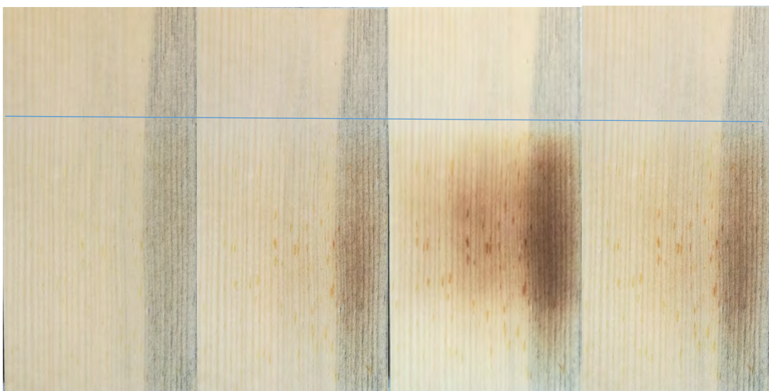
Abbildung 125 IR-Strahlung (oberer Bereich Original; unten nach 3, 4, 5, 6 min IR-Strahlung)
