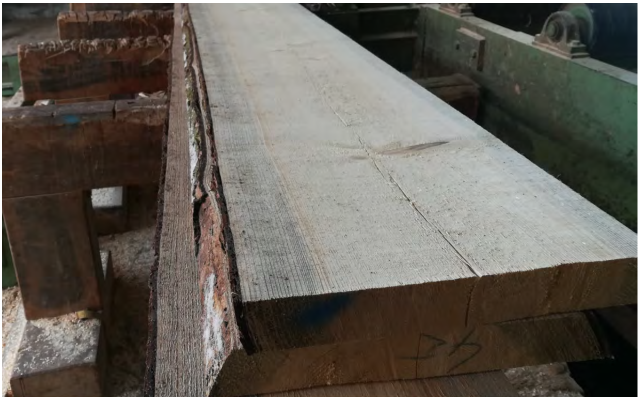
Abbildung 10 65 mm Fichtenbretter mit breit verblautem Splint
