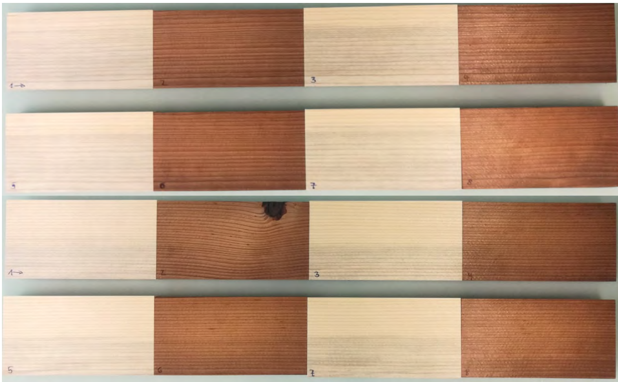
Abbildung 127 Proben der Serie 2 und 3 mit Bläue (Proben 1,3, 5 und 7 Original; Probe 2, 4, 6 und 8 thermisch behandelt)
