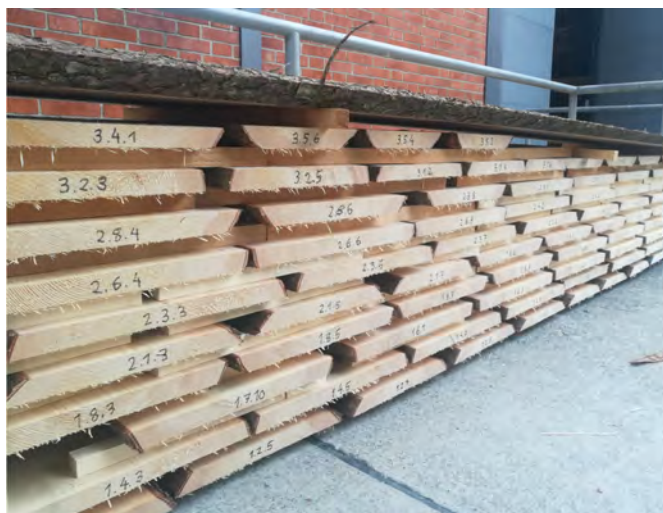
Abbildung 27 Lufttrocknung der Referenzabschnitte im Freien
