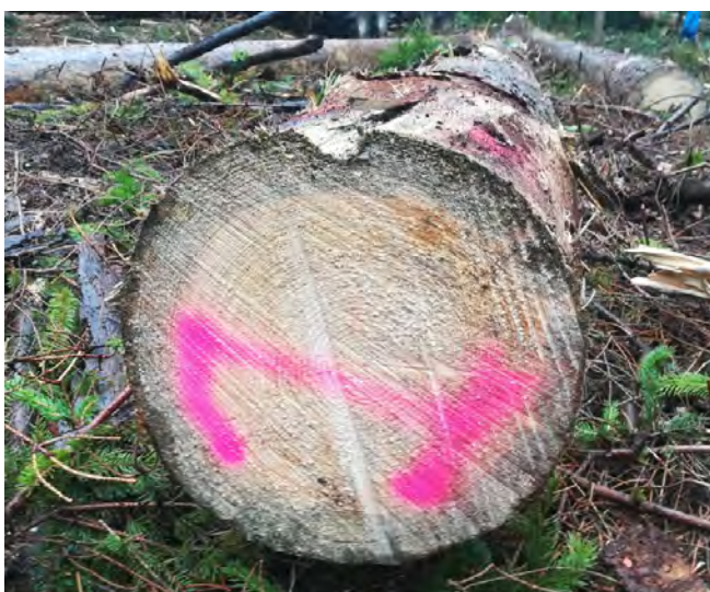
Abbildung 15 Stamm Nr.1 im oberen Teil verblaut (links) und im unteren Bereich noch unverfärbt (rechts)
