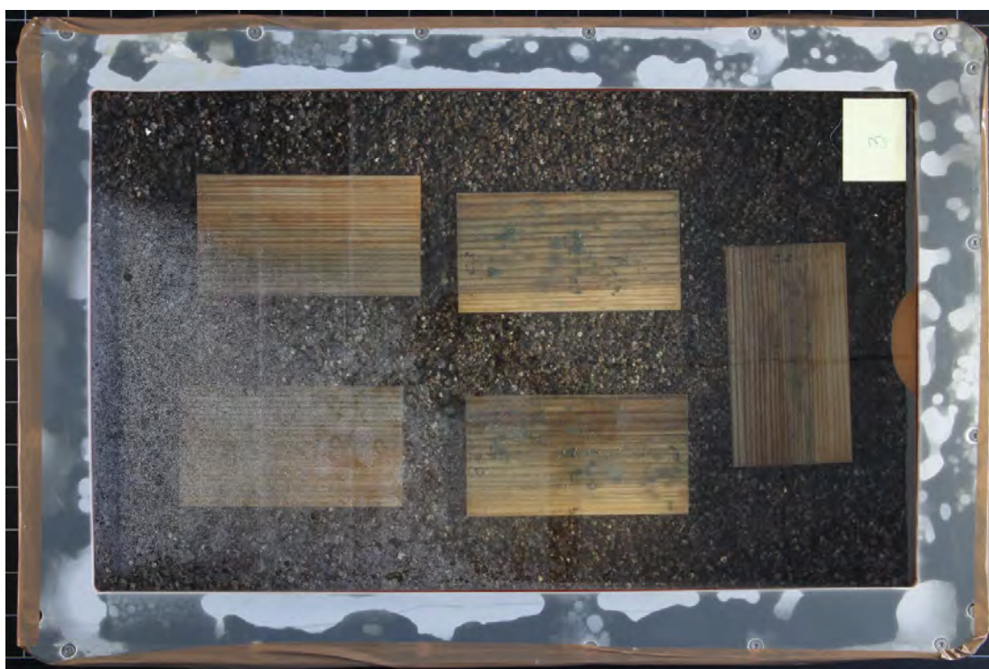
Abbildung 82 Proben der Gruppe 4 (C) nach 2 Wochen Lagerung im Klima 23°C/≈100% RH (Box 3)
