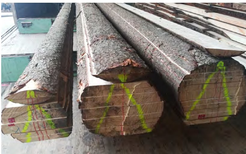
Abbildung 22 Eingeschnittene, saftfrische Fichtenholzstämme für den Abtransport zur Empa
