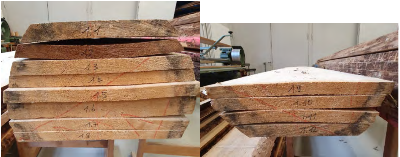
Abbildung 19 Technisch getrocknete Brettware aus Stamm 1 (Brett 1.2 gedämpft)
