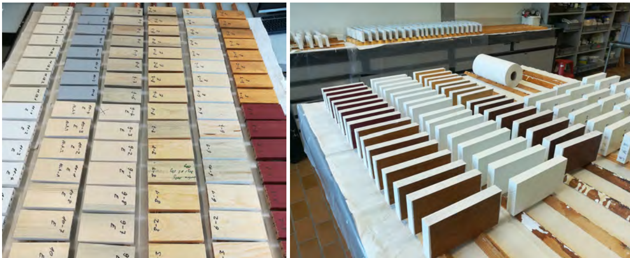
Abbildung 133 Vorbereitung der Proben; Versiegelung der Rückseite und der Schmalflächen
