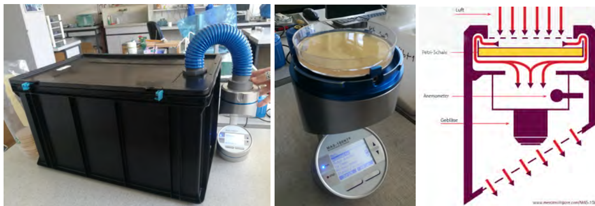
Abbildung 90 Luftkeimsammler MAS-100 NT mit Anschluss an die Testbox
