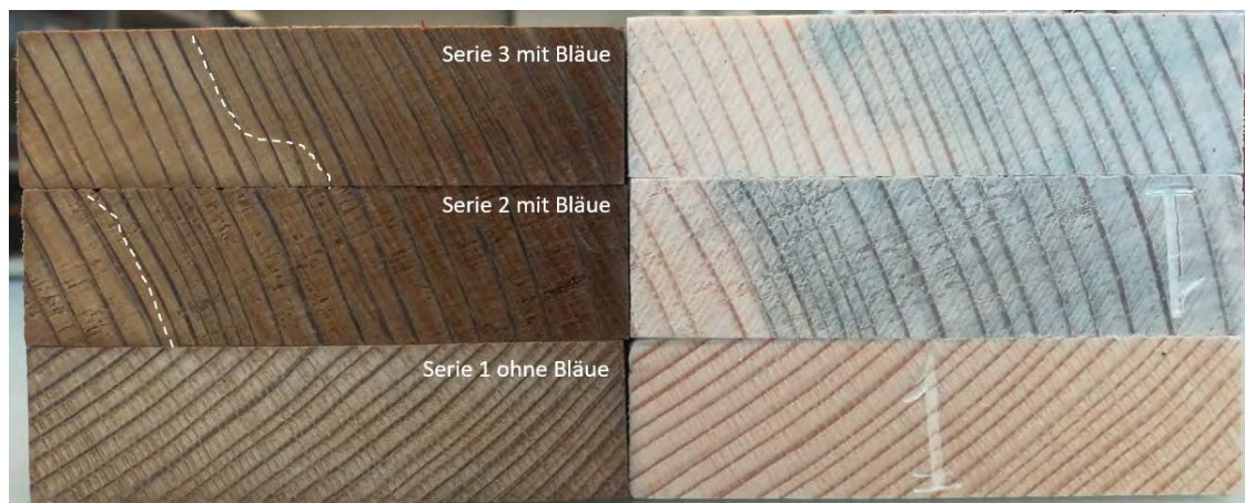
Abbildung 128 Querschnitte aufgetrennter Proben von Serie 1, 2 und 3 (Die weiss gestrichelte Linie zeigt in etwa den Verlauf der Grenze zwischen unterblauten Bereichen links und verblauten Bereichen rechts)
