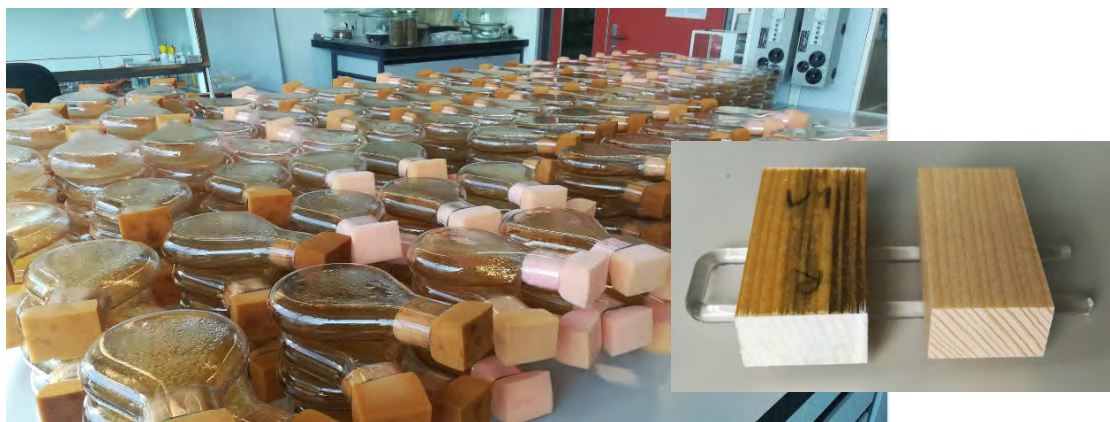
Abbildung 97 Kolleschalen mit Nährmedium vor dem Beimpfen mit Pilzkulturen; rechts: Prüfprobe und Kontrollprobe auf Glasbänkchen
