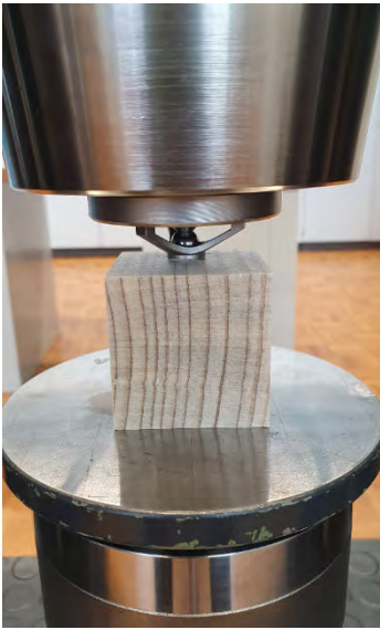
Abbildung 58 Versuchsaufbau Härte nach Brinell
