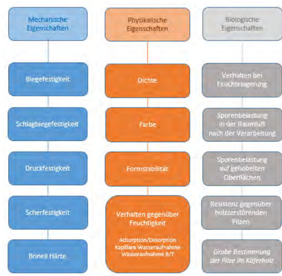
Abbildung 32 Durchgeführte Tests zur Charakterisierung des verblauten Käferholzes
