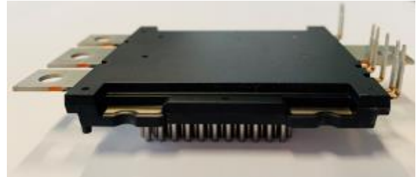
Abb. 12: Zeichnung des Halbleiter-Moduls ohne Mold-Körper gemäss endgültiger Konstruktion sowie Foto eines fertig-gestellten Prototyps.
