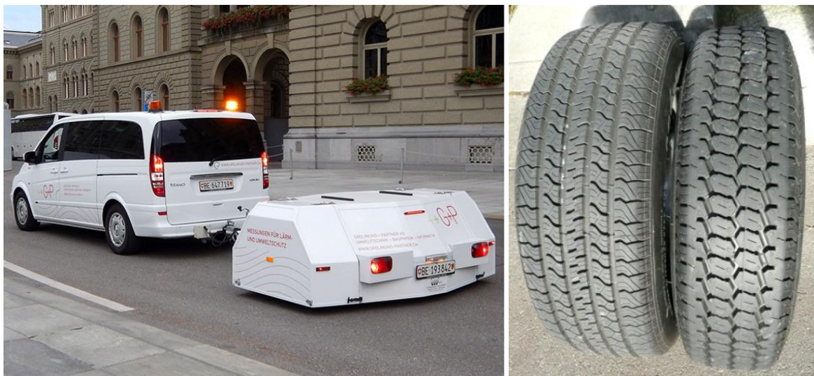
Figure 17: Remorque de mesure G+P et pneumatiques d'essai CPX P1 (gauche) et H1 (droite) d'après la norme SN EN ISO 11819-3:2021.
