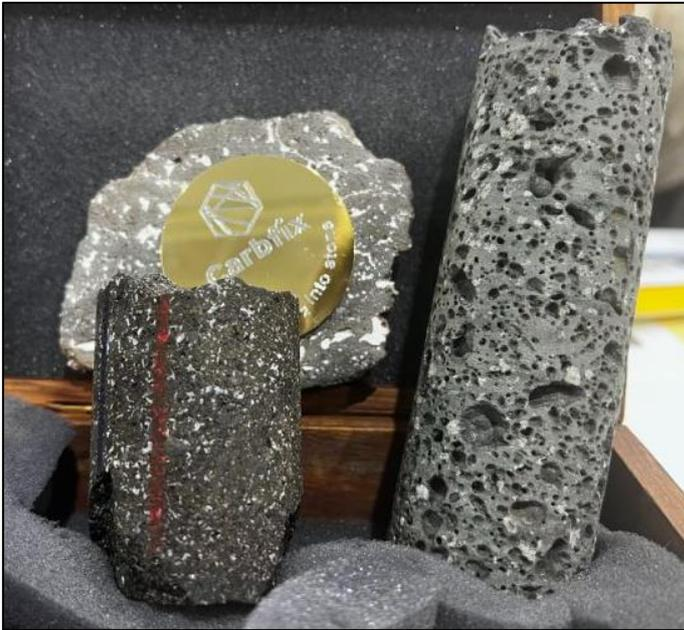
Abbildung 5: Bohrkerne aus dem CarbFix Reservoir, welche die poröse basaltische Reservoirmatrix (grau) zeigen und die neu gebildeten Karbonatminerale (= das gespeicherte CO<sub>2</sub>) in Weiss (www.carbfix.com).
