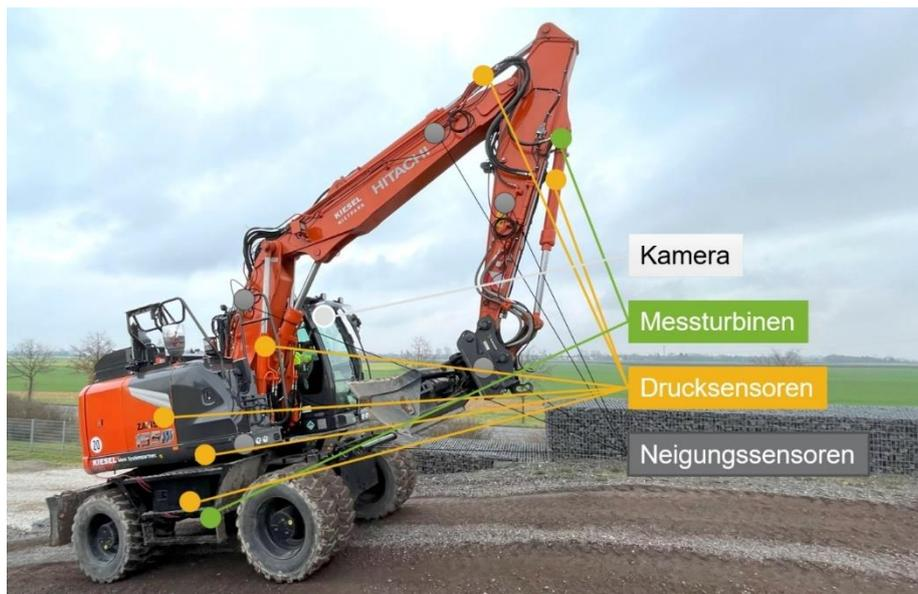
Abbildung 6: Aufbau der Sensorik für die Benchmark Messungen an einer ZX155W Dieselmachine während den Messtagen [SUNCAR].
