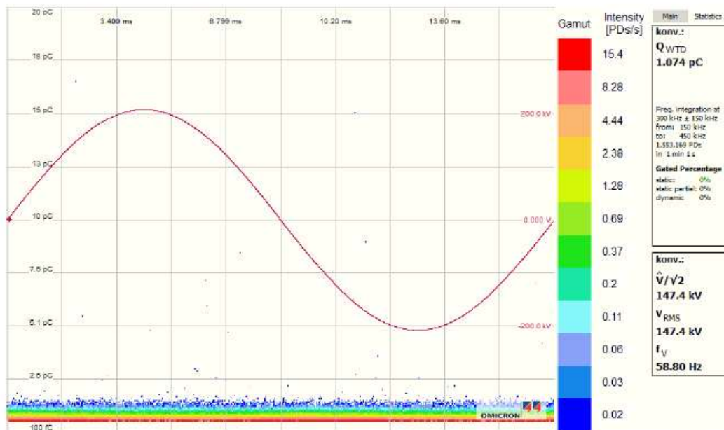
Teilentladungsbild bei 148 kV (58.8 Hz, vor Stehwechselspannungsprüfung)
