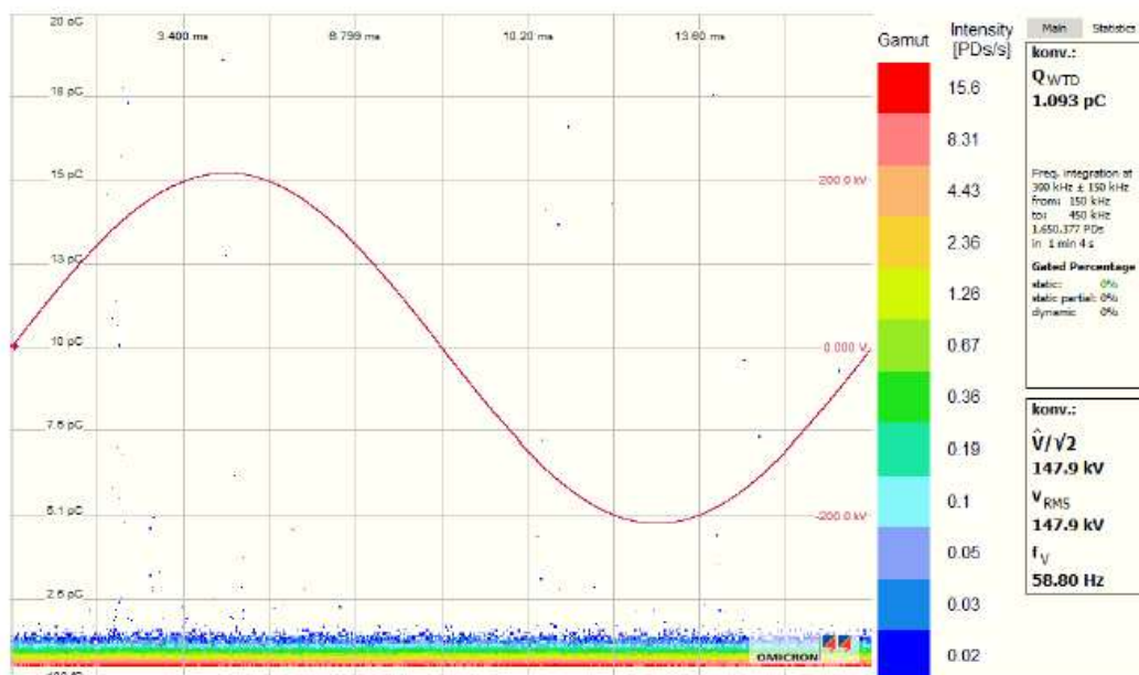
Teilentladungsbild bei 148 kV (58.8 Hz, nach Stehwechselspannungsprüfung)
