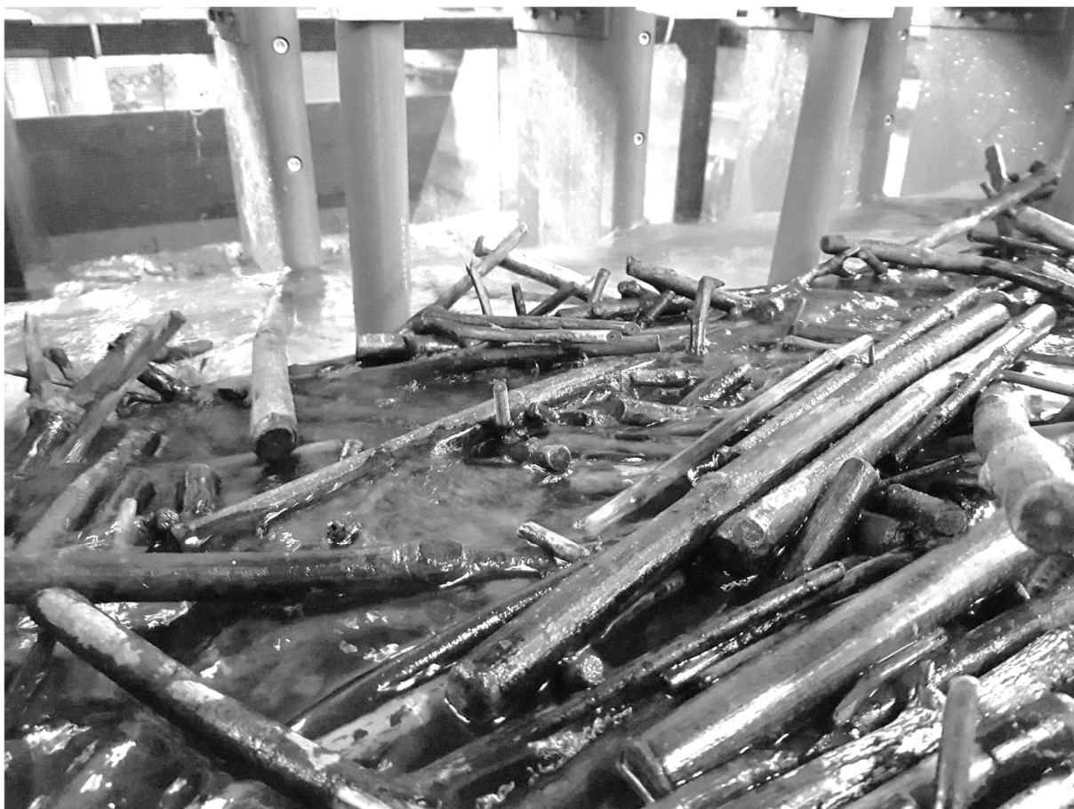
Râtelier du type « complet » étant bloqué de bois flottants dans un cours d'eau, en amont d'un déversoir vanné HEIA-FR (HES-SO) et EPFL/PL-LCH, Loïc Bénéat (test 60)
