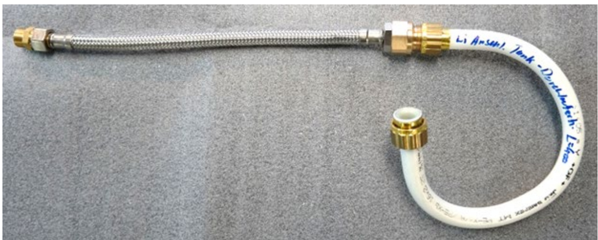
Abbildung 40 Verbessertes Handling beim anschliessen des Durchlauferhitzers mit flexiblem Panzerschlauch.
