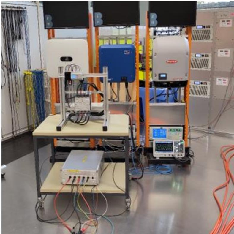
Abbildung 17: Testaufbau für den Vergleich vom Wechselrichter-integrierten und dem externen NA-Schutz im PV-Labor der BFH.
