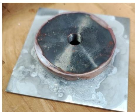
Abbildung 25: Gelötete Aluminium Stahl Probe. Die Probe wurde stahlseitig verkupfert. Die Abbildung zeigt die Probe nach dem Lötprozess im Ofen. Es konnte eine Verbindung ohne Schutzgasgespülten Ofen hergestellt werden.
