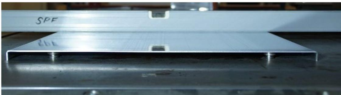
Abbildung 13: Seitenansicht des gelieferten Rollbondabsorber. Die Verbiegung des Rollbondabsorber beträgt in der Querrichtung weniger als einen Millimeter.
