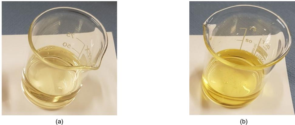
Abbildung 5: (a) Glykol-Wassergemisch vor und (b) nach dem Versuch
