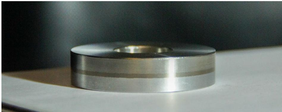
Abbildung 28: Rondelle aus plattiertem Material. Die Rondelle besteht (von oben nach unten) aus 1.4541 rostfreiem Stahl, Titan Gr1, Aluminium 1050A und Aluminium 5083.
