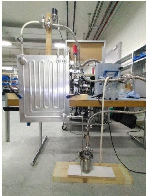
Abbildung 4: Aufbau für das Befüllen des Aktuatorkreises. In der rechten oberen Ecke des Bildes befindet sich der Rollbondabsorber mit dem Aktuator. Der Absorber ist oben über einen durchsichtigen Schlauch mit dem Drucksensor verbunden. Unten ist der Rollbondabsorber mit dem Wasser-Glykolgemisch Behälter verbunden. Auf der rechten Seite befindet sich (blau-grau) die Vakuumpumpe.
