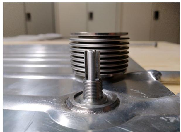
Abbildung 3: Im Vordergrund das aufgeschweisste Anschlussstück, im Hintergrund der montierte Kompensator.
