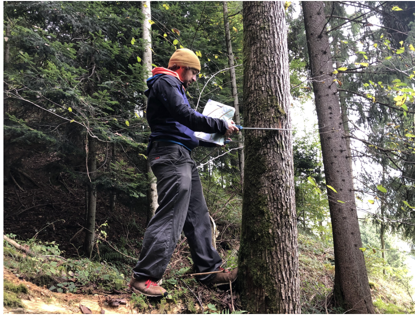
Abbildung 2.8.: Messungen im Feld der Stammdurchmessers von Trub (BE)
