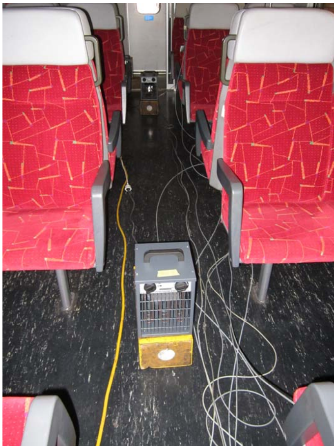
Abbildung 7: Aufheizversuch mit Heizlüftern und Temperaturmessstelle im Fahrgastraum
