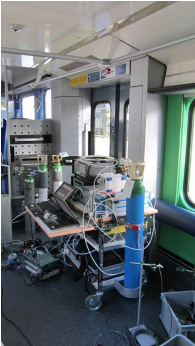
Abbildung 9: Aufbau Tracergasmessung NINA (BLS)
