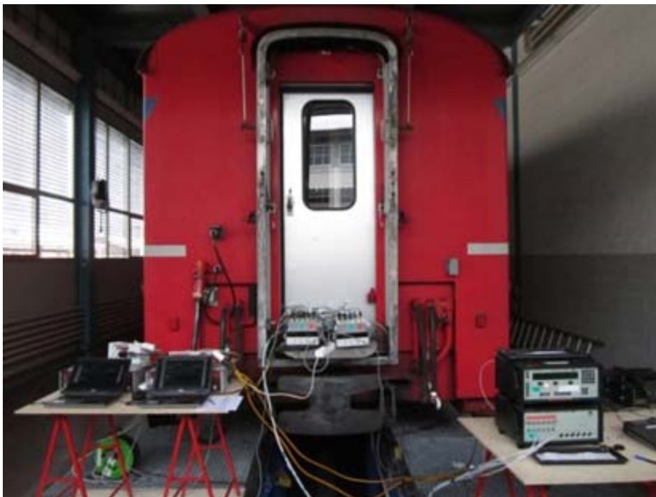
Abbildung 11: Messgeräte für den Aufheizversuch und Tracergasmessung EW II (RhB)
