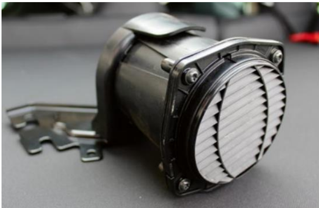
Abbildung 4: Lautsprecher eines AVAS [9]
