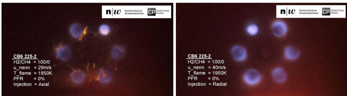
Abbildung 82: CB6 225-2 Flashback im Brennerrohr 3 (axiale Eindüsung) und Brennerrohr 2 (radiale Eindüsung)
