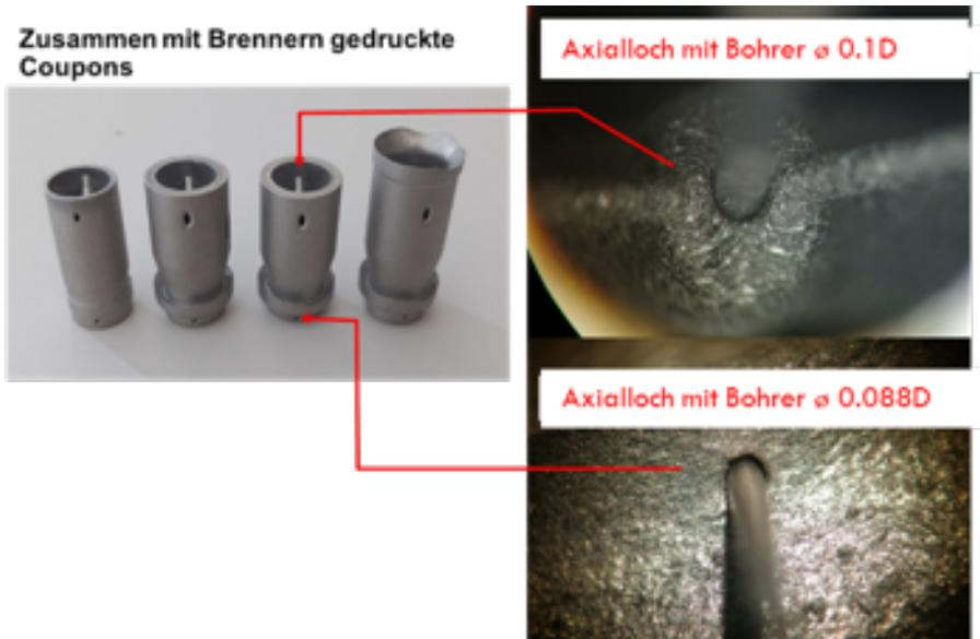
Abbildung 63: Bestimmung der Brennstoffdüsendurchmesser
