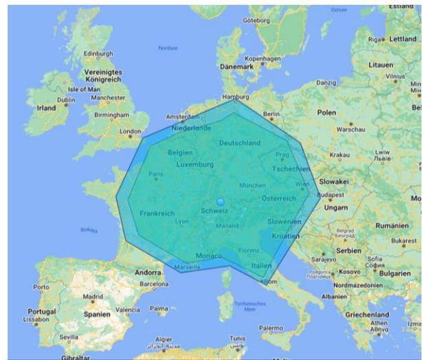
Abbildung 15: Potenzielle Transportdistanz für Grasplatte/Zellulosedämmstoff (grössere Fläche) und Strohplatte für ein Holz-MFH basierend auf Glaswolle mit Ziel Zürich.
