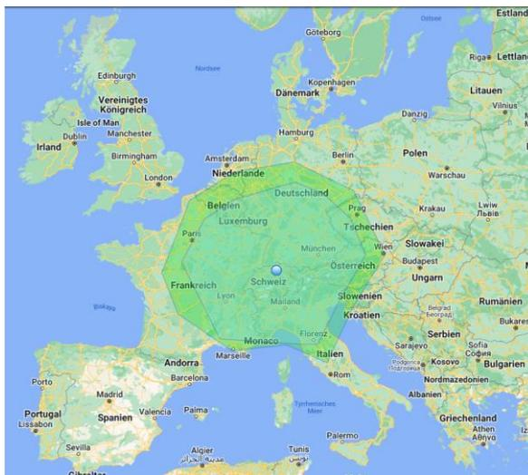
Abbildung 14: Potenzielle Transportdistanz für Grasplatte/Zellulosedämmstoff (grössere Fläche) und Strohplatte für ein Beton-MFH basierend auf Glaswolle mit Ziel Zürich.
