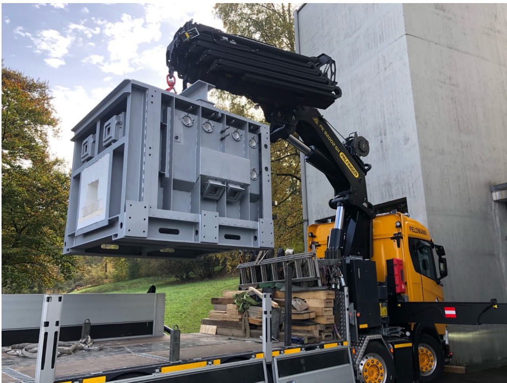
Abbildung 2 Entladung des neuartigen Forschungs-ofens an der ETH Zürich
