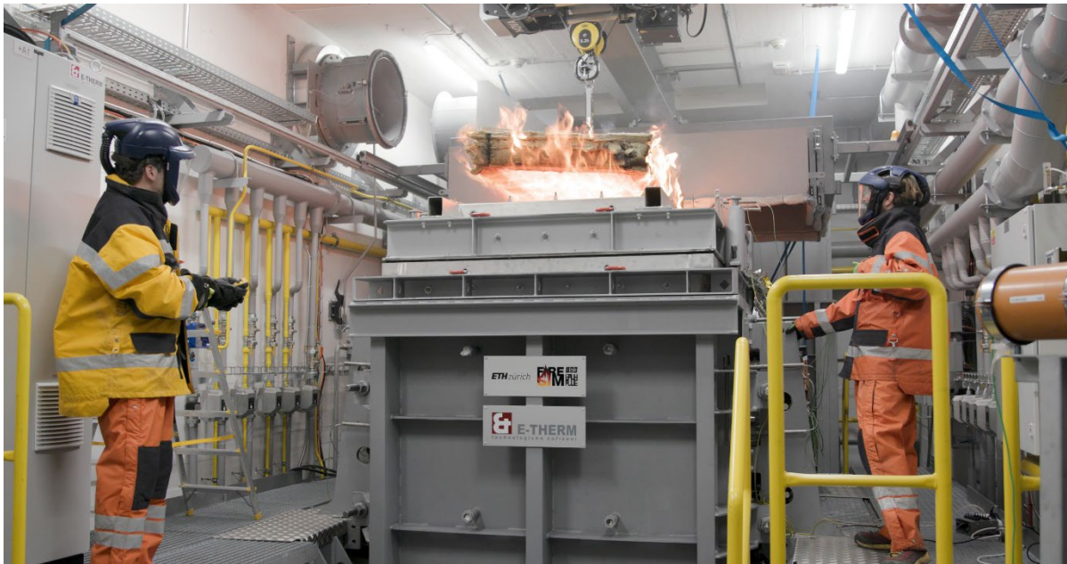
Abbildung 6 Brandversuch an einer Brettsperrholzplatte
