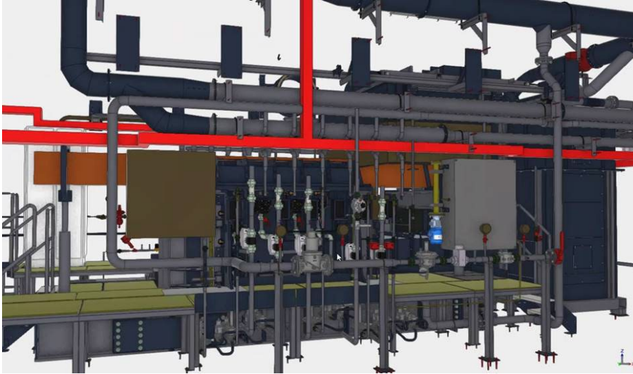
Abbildung 1 Visualisierung des neuartigen Forschungs-ofens an der ETH Zürich
