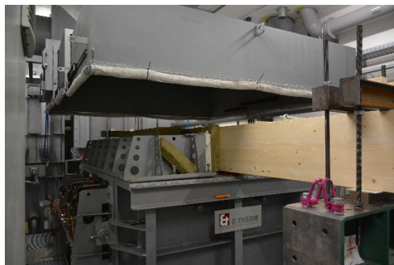
Abbildung 3 Durchgeführte Brandversuche für die Prüfung der Funktionen und der Leistung des Forschungsofens: links mit belastetem BSH Balken (Test C), rechts mit Wand- und Deckenelement aus Brettsperrholz (Test A)
