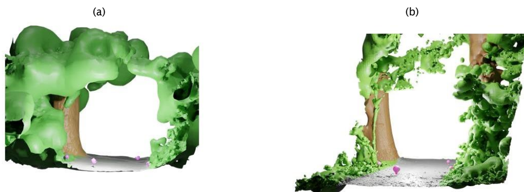
Abbildung 38: Visuelle Gegenüberstellung der Erfassung des Lichtraumprofils zur Beurteilung der Passierbarkeit der Strasse zwischen (a) Blickfeld Cube 1 und (b) FARO® Focus 3D Scans.
