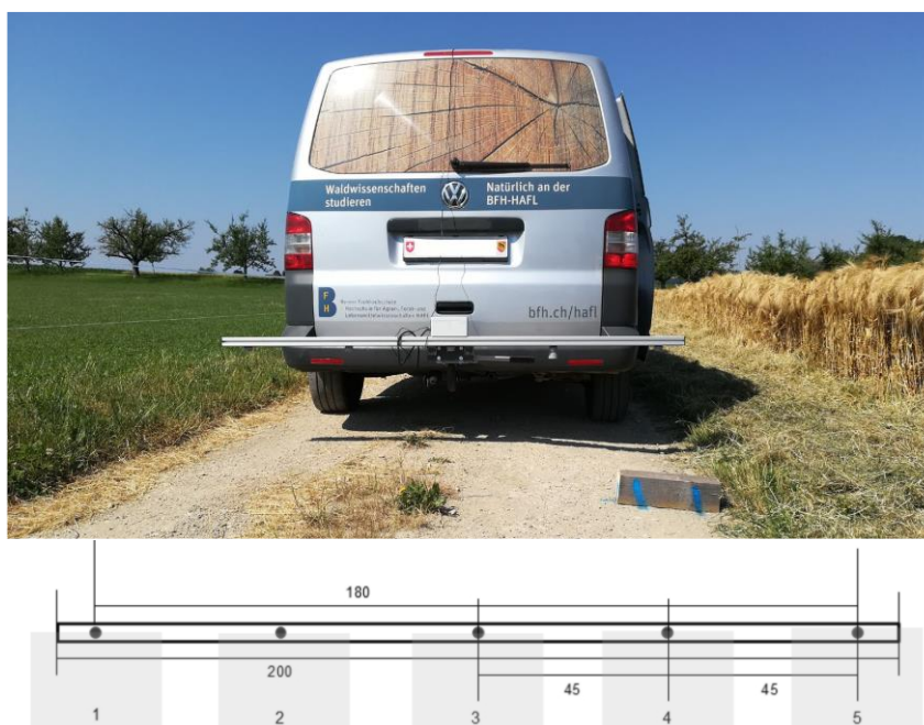
Abbildung 28 : Montage der Messlanze an der Anhängerkupplung eines PKWs zur Erfassung des Querprofils einer Fahrbahnoberfläche (oben) auf einer Breite von 180 cm mittels 5 montierter Ultraschallsensoren im Abstand von 45 cm (unten)
