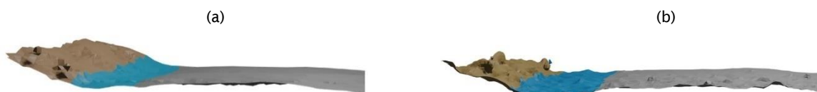
Abbildung 35: Vergleich von Strassengeometrie und Erfassung der Oberflächenrauigkeit. (a) Darstellung eines Scans des Cube 1 und (b) des Focus 3D in Mesh- Ansicht
