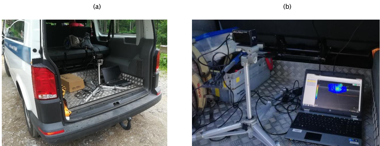
Abbildung 31: (a) Messaufbau zur Anwendung des Cube 1 aus dem fahrenden PKW, montiert auf einem Stativ mit (b) Detailansicht mit Echtzeitdarstellung des Scanbereichs
