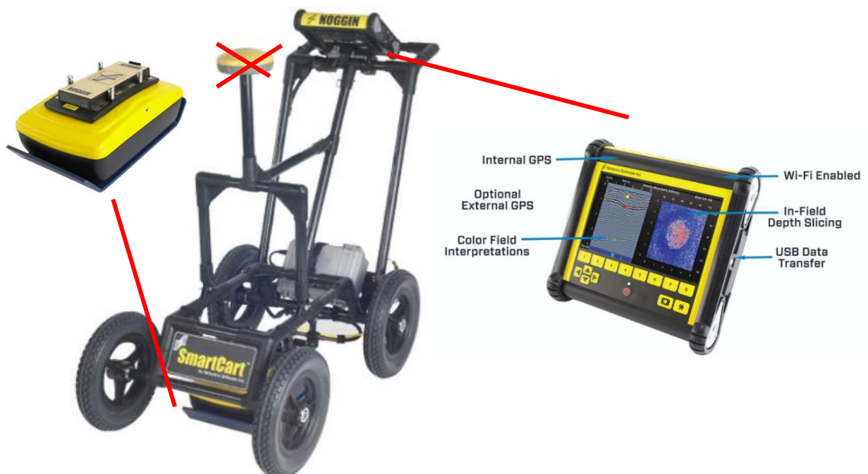
Abbildung 7: Für das Projekt verwendete FMCW-GPR-Hardware (Sensors & Software Inc. 2021b, verändert)
