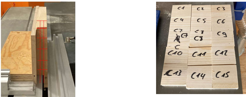
Abbildung 3.1 Sägeraster einer Lamelle (links) und Zuschnitt der Proben aus der Lamelle A (rechts) für die Messung der Sorptionsisotherme
