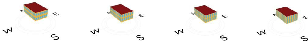
Abbildung 2-2: Parametrische Untersuchung der Fensterhöhen (1,6 m bis 2,8 m, Fensteranteil konstant bei 0,35)
