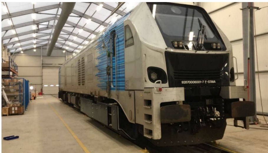
Abbildung 2-11: Shift2Rail-Projekt DYNAREIGHT: Sechssachsige Lokomotive mit Schallschürzen. (aus [34, S. 19])
