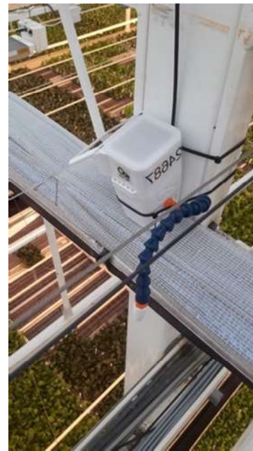
Figure 19 – Photo du capteur de mesure de la température / humidité / radiations au-dessus de l'écran Infrascreeen
