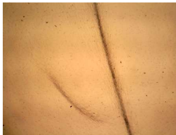
Figure 36 – Apparition de pliures et de fissures associées lors des cycles de pliage (photo 2)
