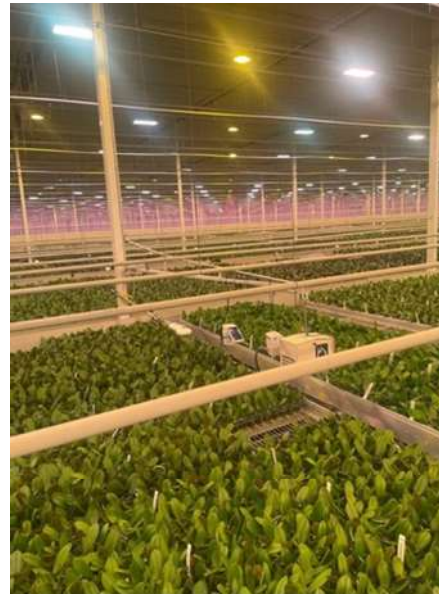
Figure 17 – Photo du capteur de mesure des radiations thermiques / solaires entrantes / sortantes
