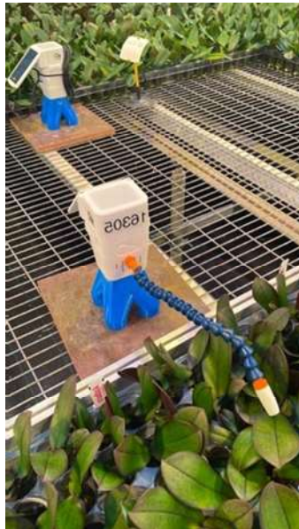
Figure 16 – Photo du capteur de mesure de la température foliaire / de la température de l'air et de l'humidité relative.
