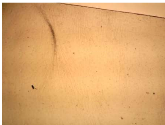
Figure 35 – Apparition de pliures et de fissures associées lors des cycles de pliage (photo 1)
