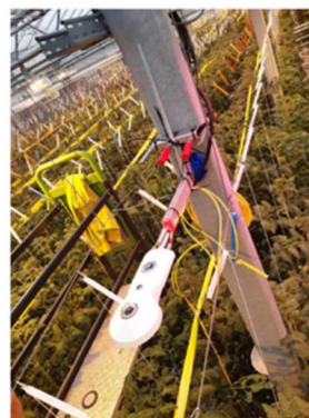
Figure 24 – Photo du capteur de mesure des radiations thermiques / solaires entrantes / sortantes
