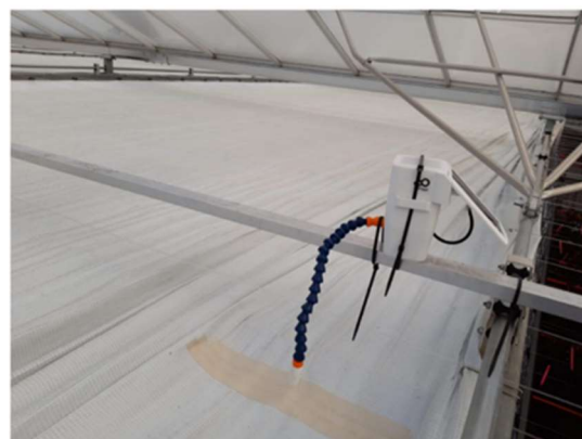
Figure 22 – Photo du capteur de mesure de la température de l'écran 2 dans le compartiment 21
