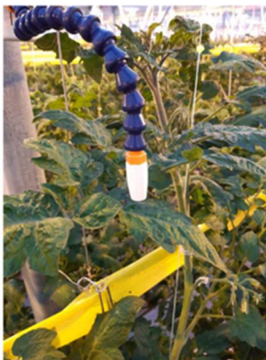
Figure 21 – Photo du capteur de mesure de la température foliaire
