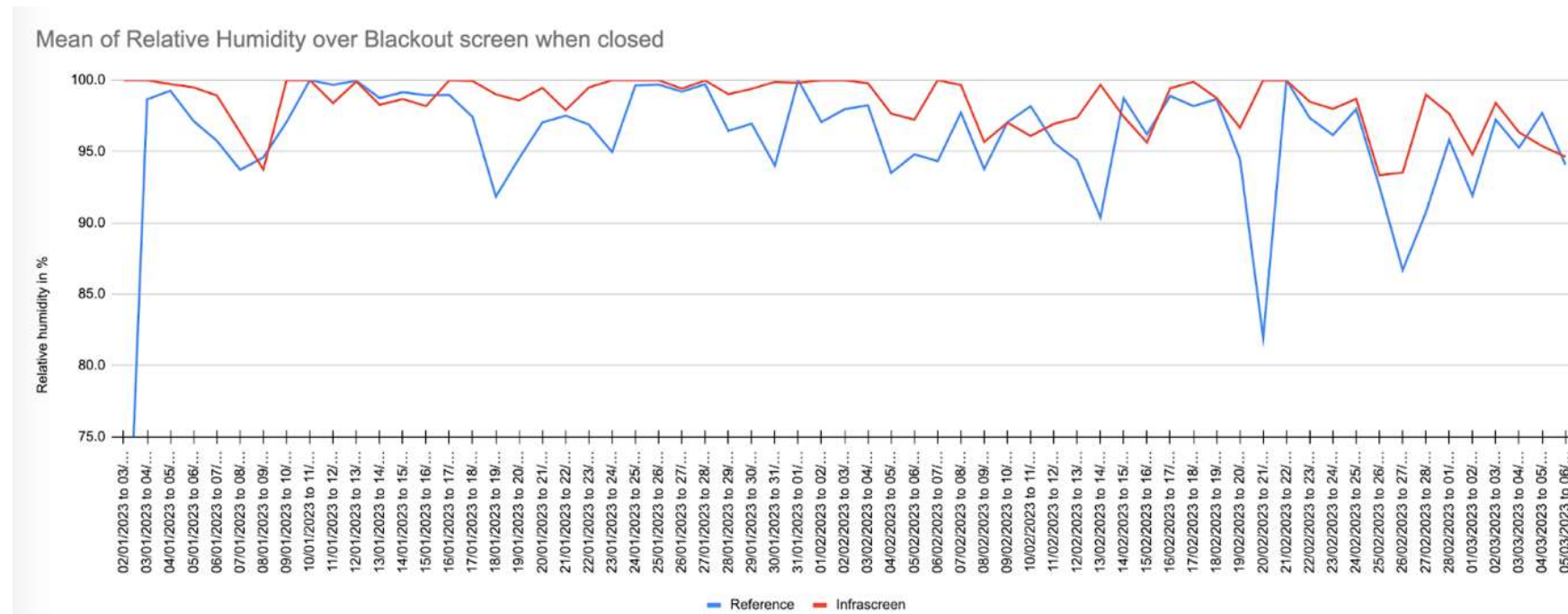
Figure 50 - Humidité relative au-dessus de l'écran d'ombrage aluminisé entre le 02 Janvier 2023 (date d'installation du capteur) et le 05 Mars 2023. En rouge l'humidité relative au-dessus de l'écran 3 dans le compartiment de test (9) et en bleu dans le compartiment de référence (6).
