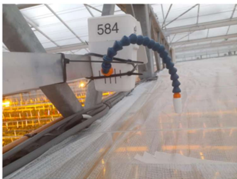
Figure 23 – Photo du capteur de mesure de la température de l'écran 1 dans le compartiment 21
